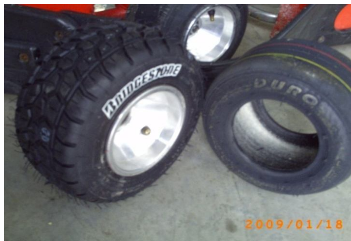
Fig. 2.1.5.1. Neumáticos para tierra y para pista asfaltada
