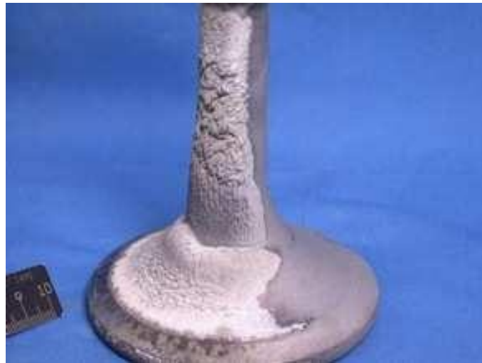
Figura 3. Válvula con depósitos de un motor de gas de depuradora
