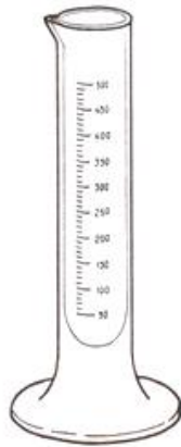
Figura 15. Probeta graduada para la medición de aceite, que servirá para conocer las dimensiones de la cámara de combustión.
