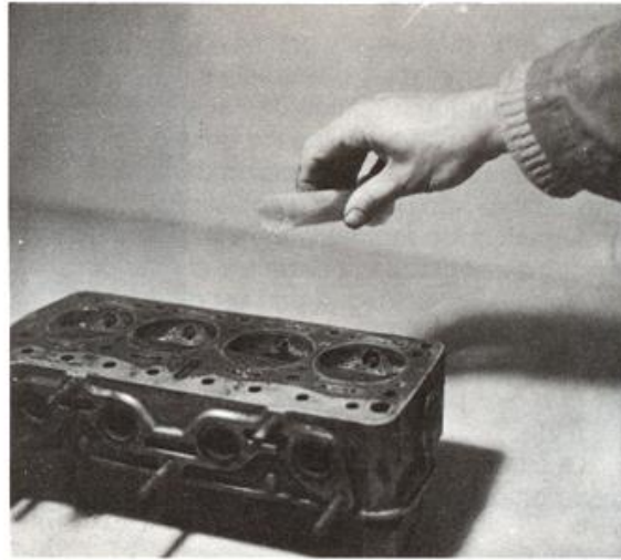
Figura 16. Forma de comprobar la medida de una cámara de combustión a base de llenar su volumen con aceite.
