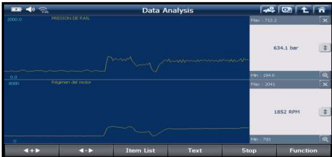
Figura 38. Forma de la onda a 1800 RPM. Autor: Alex Garófalo.
