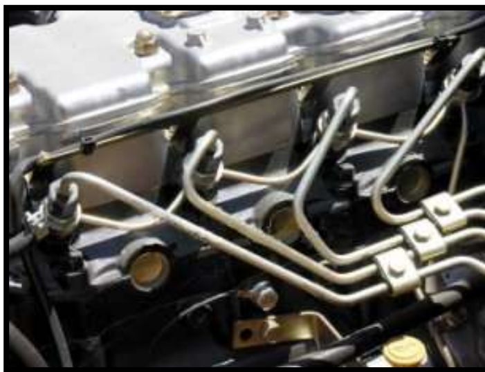
Figura 19. Cañerías de alta presión. Fuente: Manual Common Rail Delphi Editado por: Alex Garofalo.
