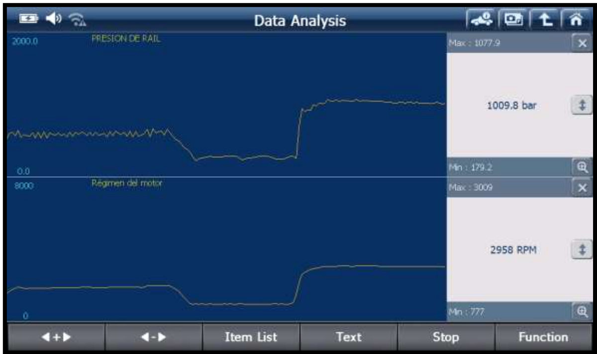
Figura 39. Forma de la onda a 3000 RPM. Autor: Alex Garófalo.
