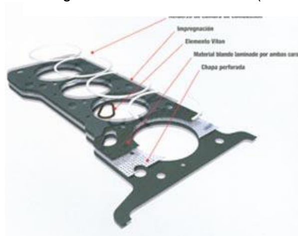
Figura 1. 14 Junta de Culata (amianto)
