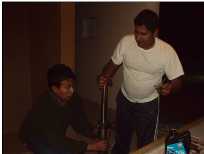
Figura 4.12. Lubricación de cilindro hidráulico
