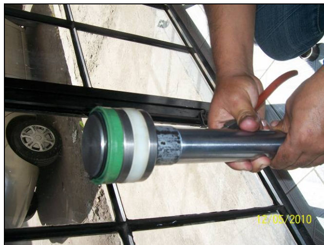
Figura 4.9. Fijación de retenedores (Porta empaques)
