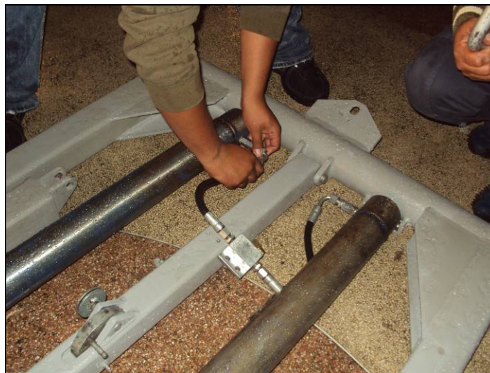
Figura 4.11. Fijación de cilindros hidráulicos (Conjunto cama fija y móvil)
