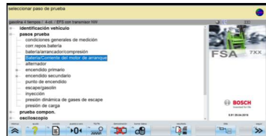
FIGURA 3.- Imagen que muestra el primer paso para ingresar a la pantalla de prueba de Batería/Corriente del motor de arranque
