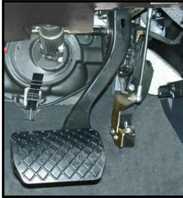
**Figura 2.5** Pedales con accionamiento mecánico
