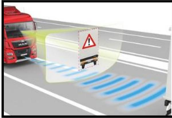
**Figura 2.8** Sistemas (EBA Asistencia de frenado de emergencia)
