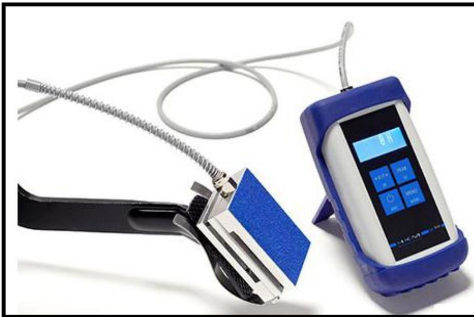
**Figura 3.18** Dinamómetro digital
