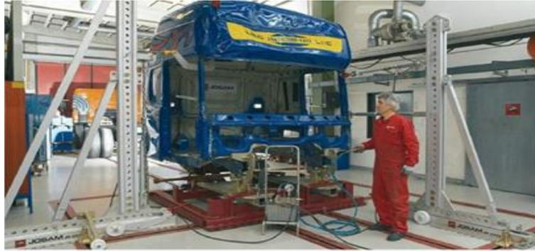
**Figura 17.** Enderezador de cabinas
