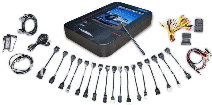
**Figura 28.** Scanner para motores diésel
