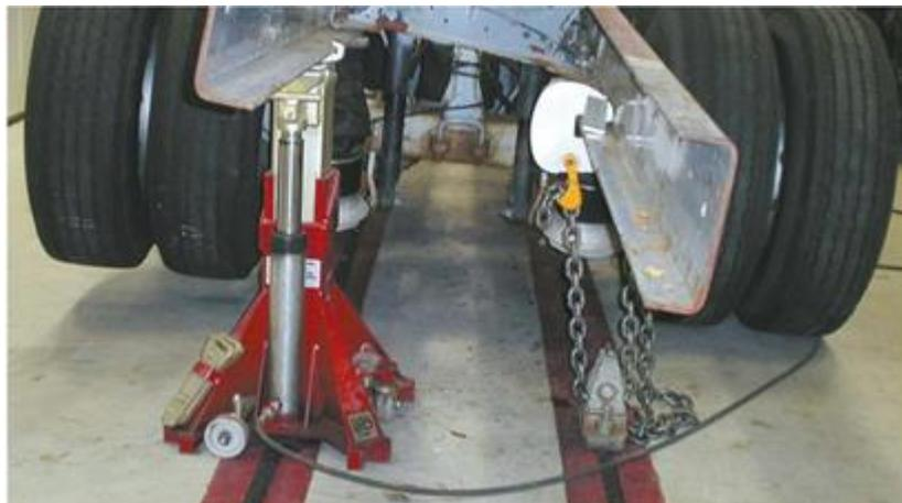
**Figura 14.** Columna hidráulica
