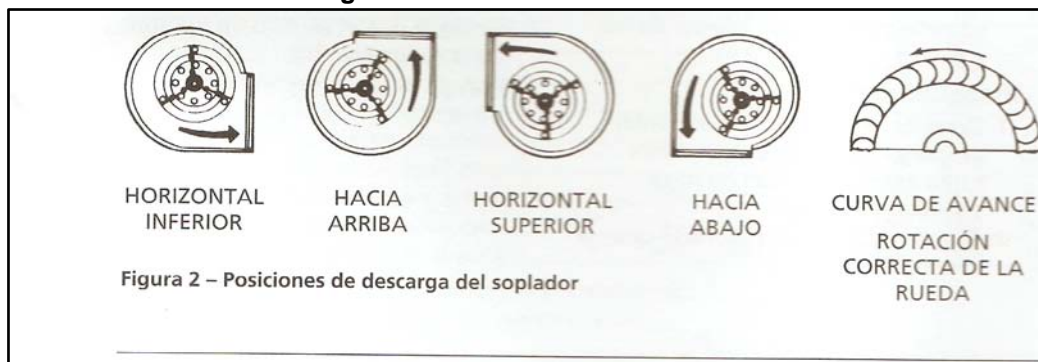
Figura 3.13. Posiciones del extractor
