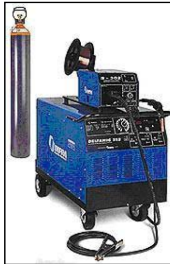
Foto 2.5 Equipo de soldadura MIG
