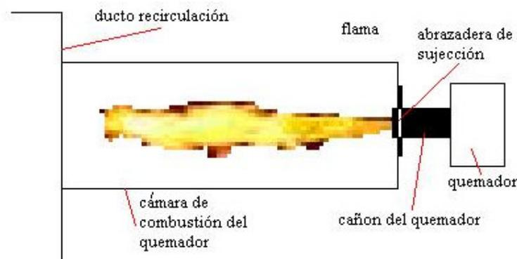
Figura 3.45. Esquema montaje del quemador y la flama
