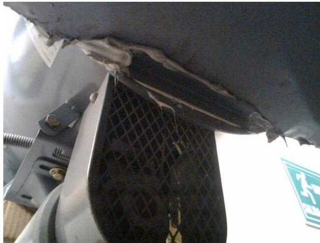
Figura 3.3. Silicona sellante y ángulo de sujeción
