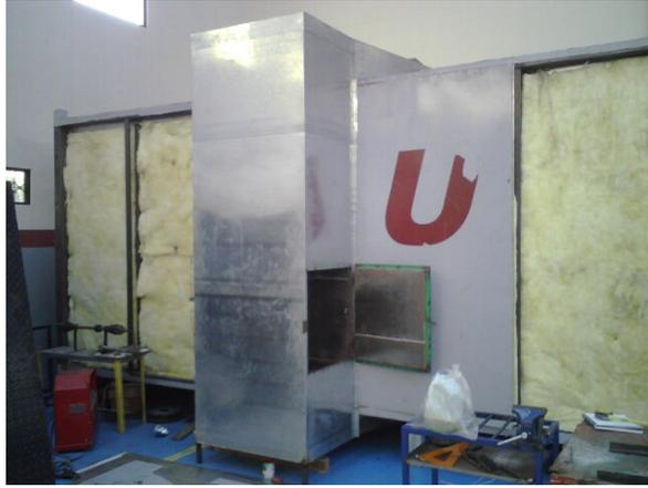
Figura 3.37. Ducto de recirculación montado.
