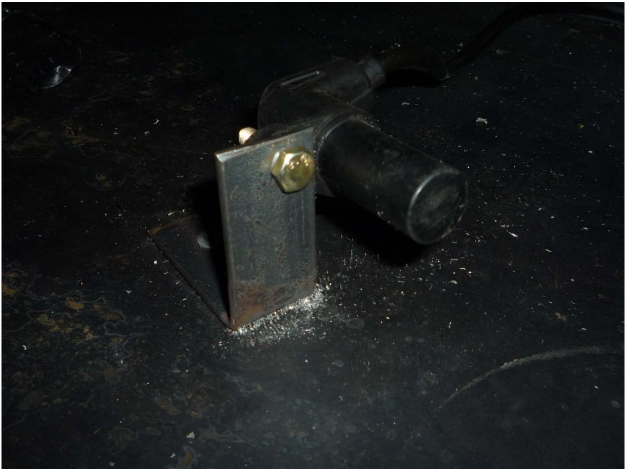
Figura 4.18 Sensor CKP fijado a la platina.
