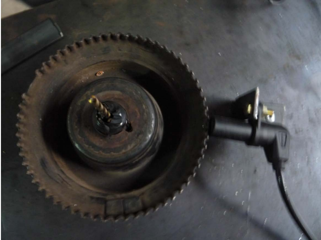
Figura 4.19 Ubicación del sensor CKP cerca de la polea.
