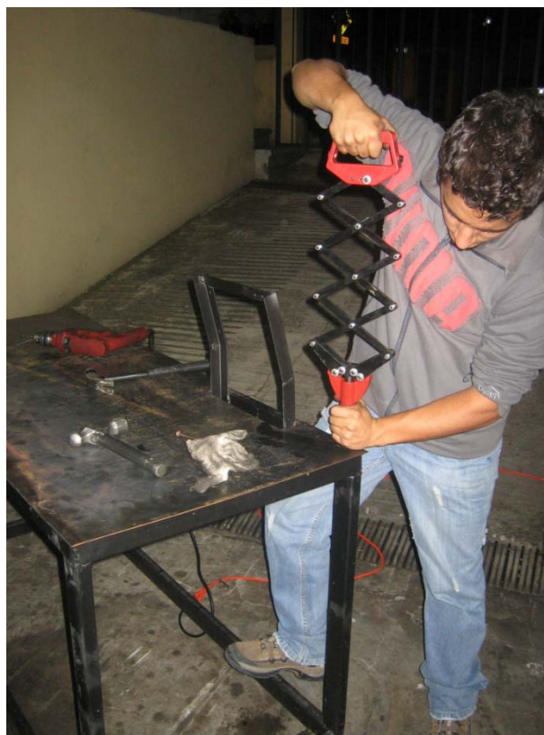
Figura 4.5 Remachado de planchas de tol.
