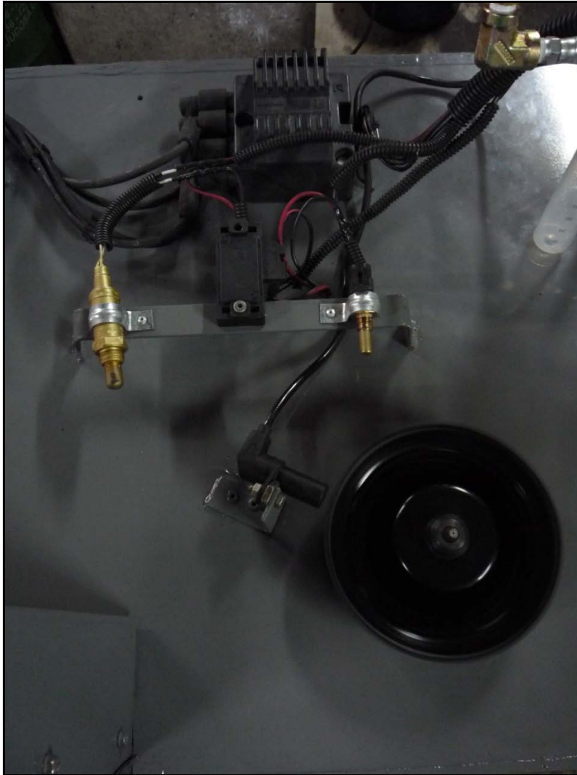
Figura 4.20 Ubicación de los sensores (O2, MAP y ECT).
