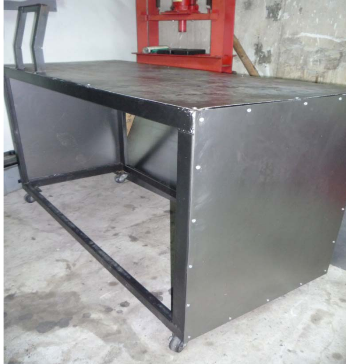
Figura 4.6 Planchas de tol remachadas.
