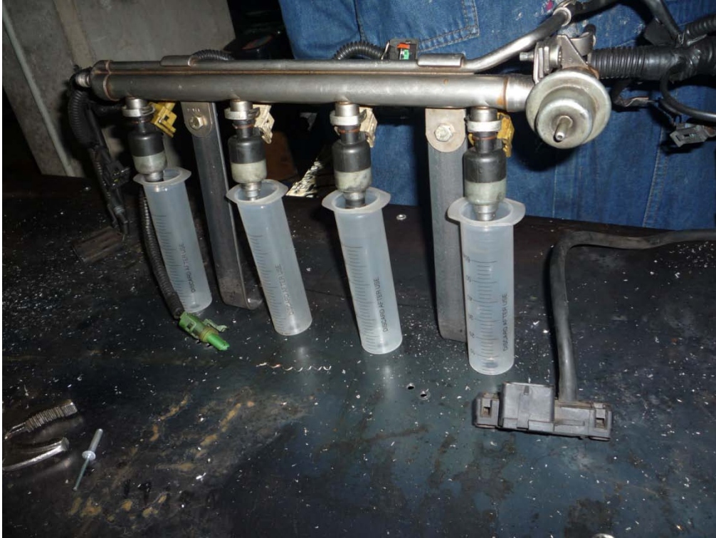
Figura 4.12 Ubicación de la riel de inyectores en la maqueta.
