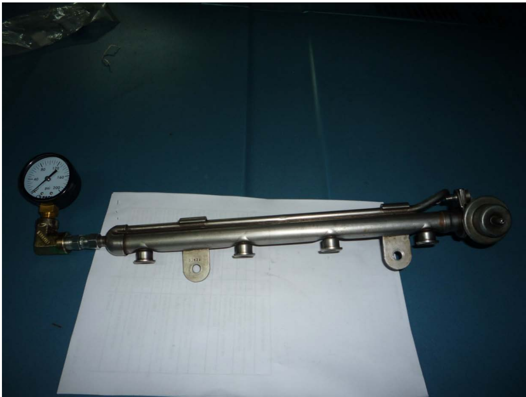
Figura 4.11 Riel de inyectores con manómetro de presión.
