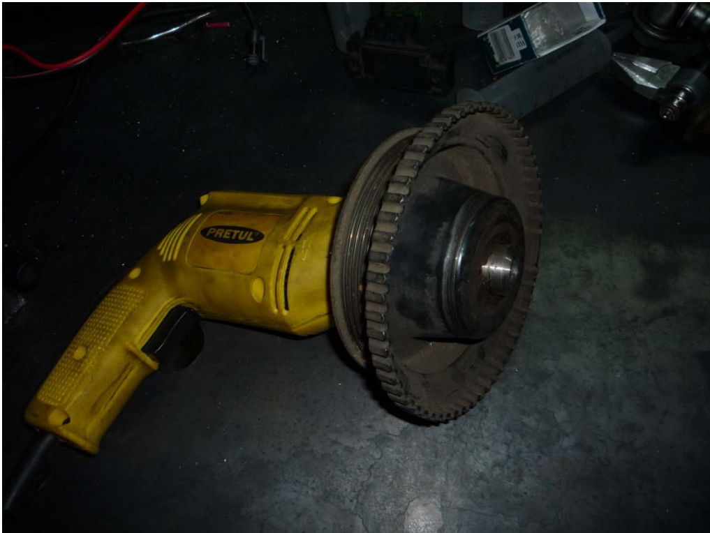
Figura 4.17 Polea del cigüeñal fijada al taladro.
