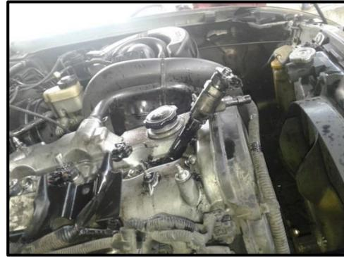
Figura 12. Desmontaje del inyector CRDI
