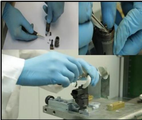
Figura 14. Desarmado del inyector CRDI
