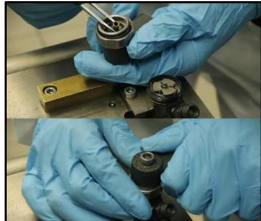
Figura 16. Ensamble del inyector CRDI
