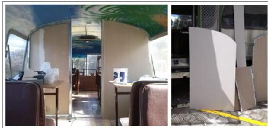
Figura 3.74 Montaje de nueva división interior
