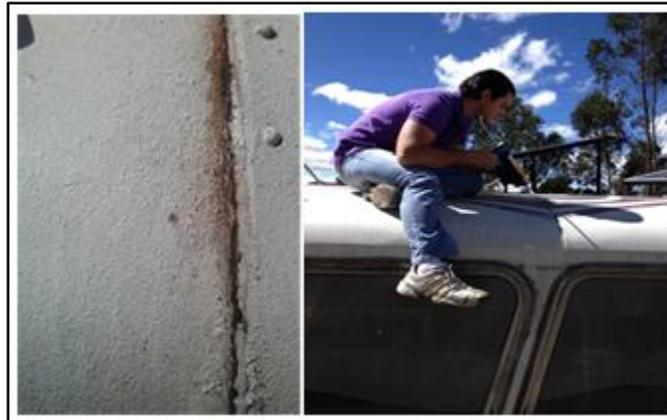
Figura 3.72 Trabajos de impermeabilización del techo del bus de la UIDE.
