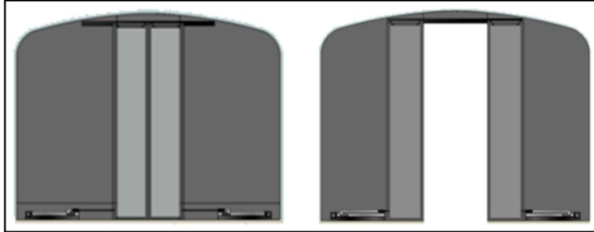
Figura 3.7 Diseño de puertas corredizas a implementar en bus de Transportes Ecuador.
