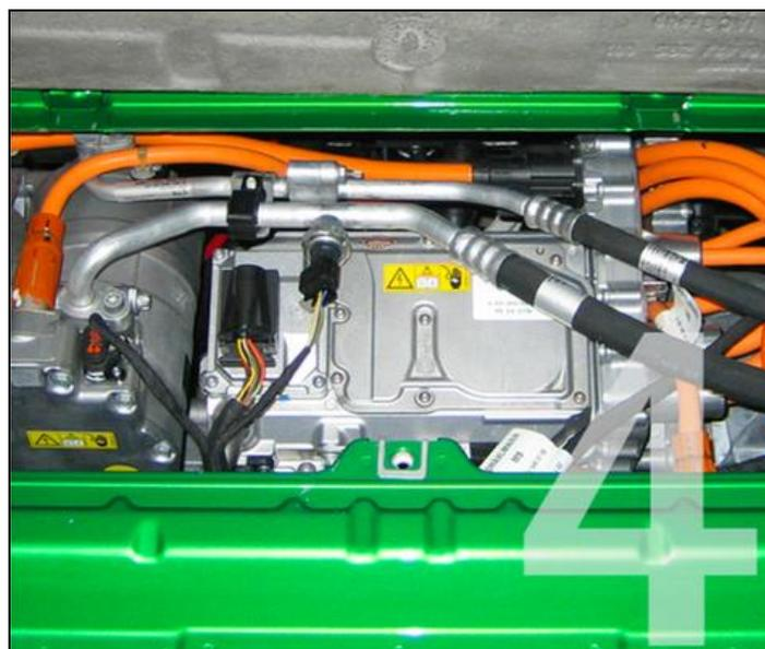
**Figura 2.10:** Convertidor electrónico de potencia
