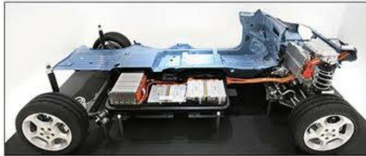
**Figura 2.23:** Ubicación de la baterías en un vehículo eléctrico.
