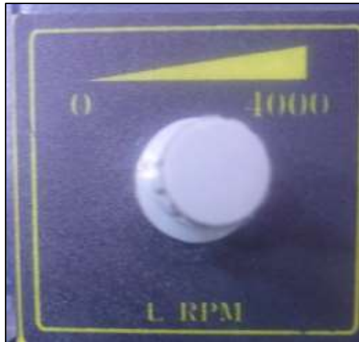
Figura. 25 Potenciómetro de velocidad Fuente: El autor
