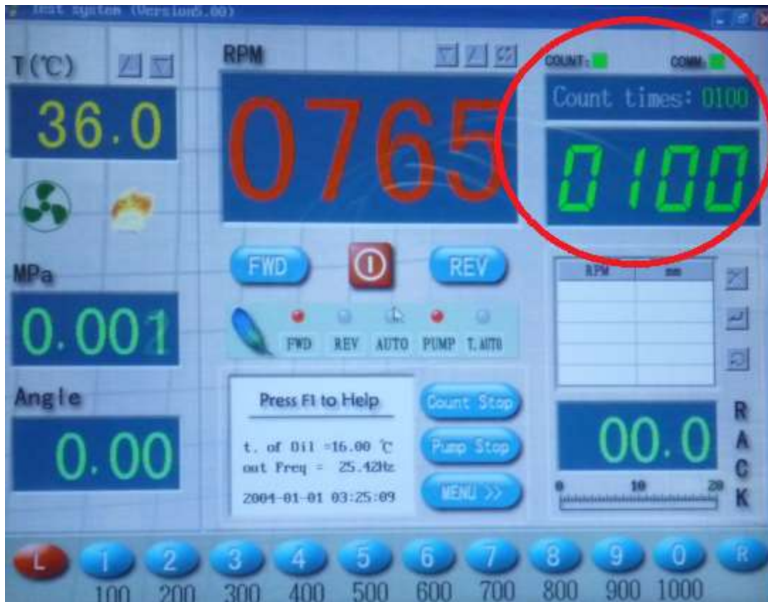
Figura. 26 Tiempo de conteo de inyección (Strokes) Fuente: El autor
