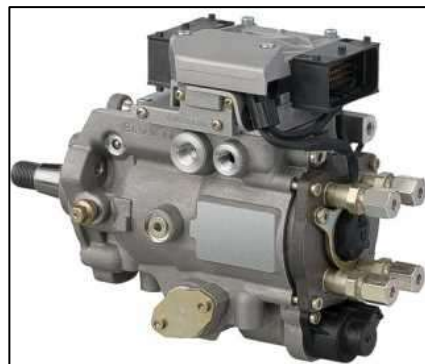
Figura. 6 Bomba de inyección rotativa Fuente: Bombas de inyección, para motores diésel
