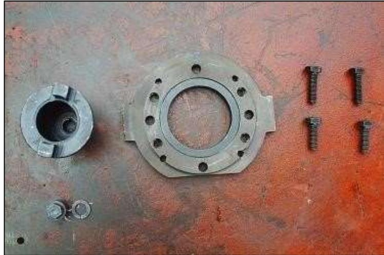
Figura. 26 Acoples para sujeción de la bomba al banco
