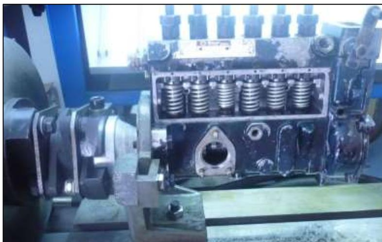
Figura. 29 Colocación de la bomba en el banco
