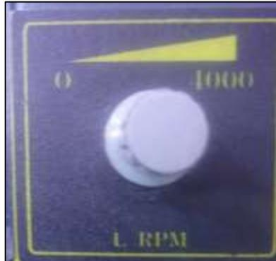
Figura. 32 Potenciómetro de velocidad
