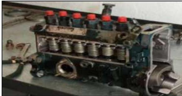
Figura. 25 Extracción de la bomba auxiliar y la tapa lateral.
