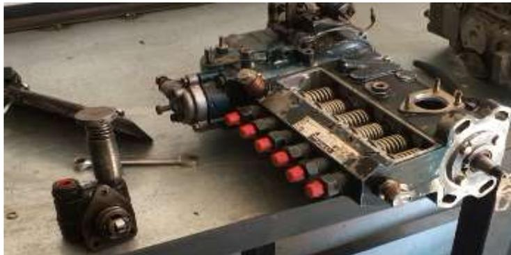
Figura. 24 Extracción de la bomba auxiliar y la tapa lateral.
