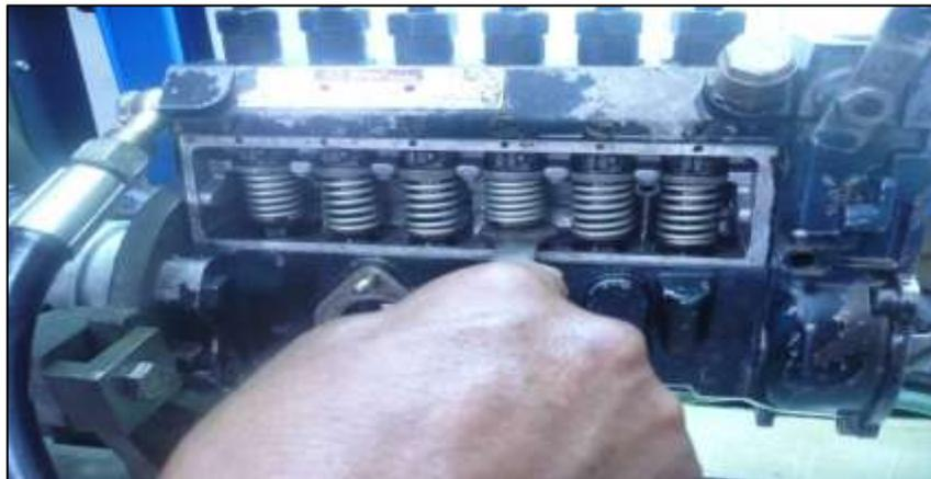
Figura. 35 Calibración de los cilindros descalibrados
