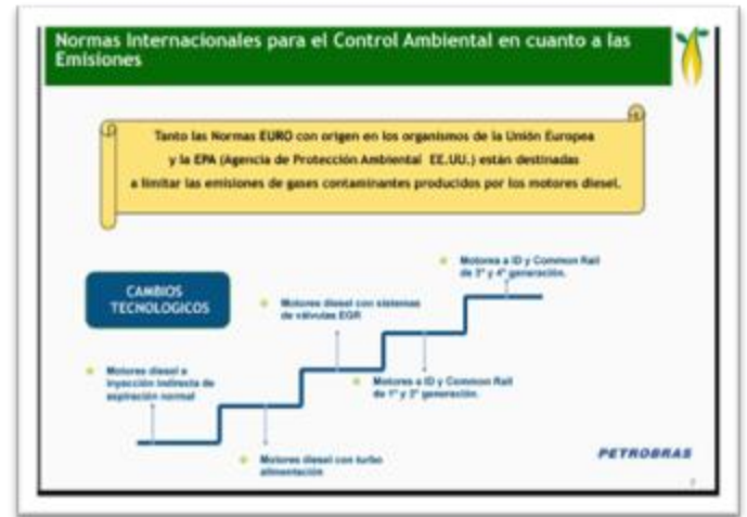
Figura 12: Cambios Tecnológicos en los Motores Diésel según la Evolución de las Normas Ambientales.
