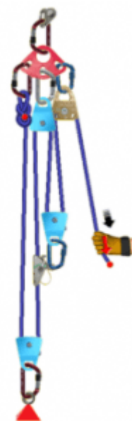
Ilustración 89.- Polipasto compuesto Autor: Granvertical.com
