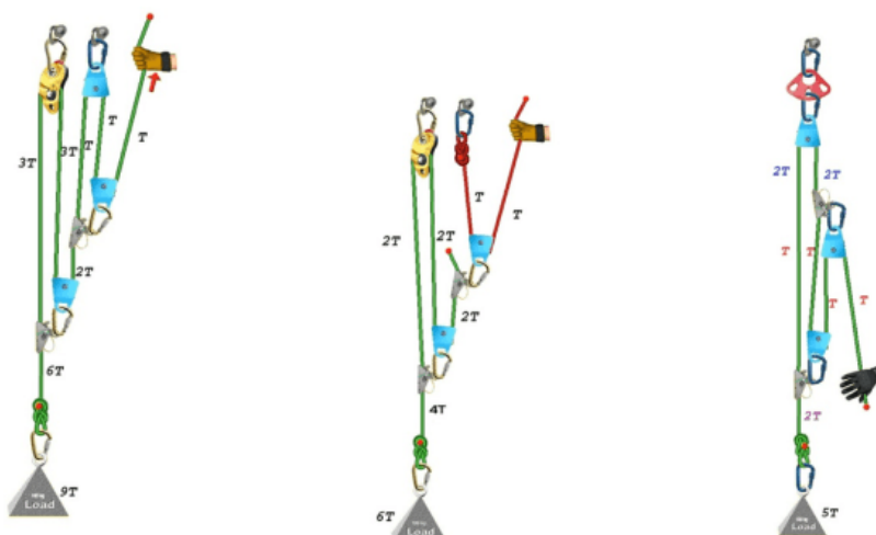
Ilustración 91.- Tipos de polipasto compuestos Autor: Granvertical.com
