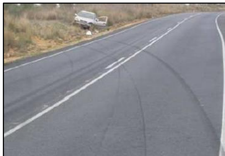
Figura. 26. Huella de Derrape.
