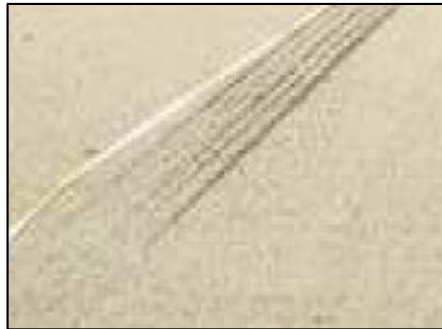
Figura. 25. Huella de Aceleración
