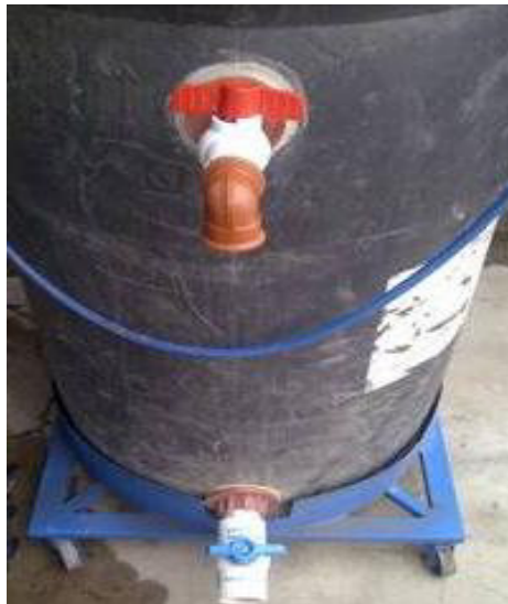
Figura 4. 20 Válvulas de biol y control de gasómetro
