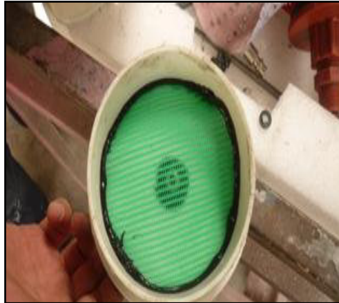
Figura 4. 7 Filtro DE H 2 S (sellado con malla)
