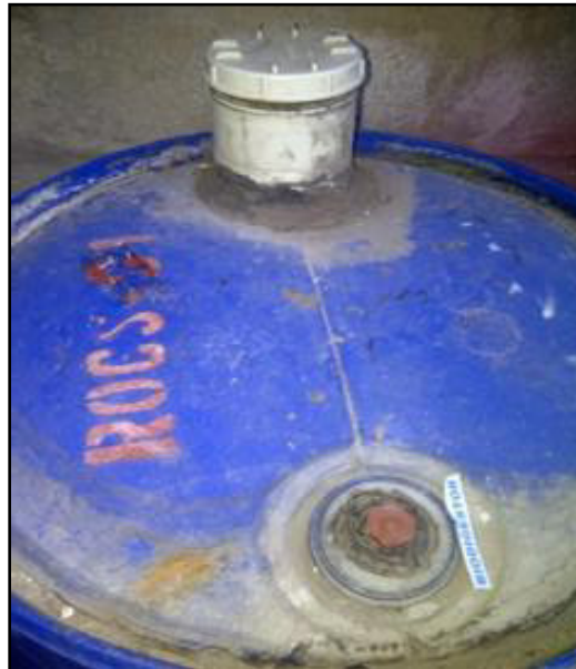
Figura 4. 12 Biodigestor plástico (Tomas roscadas de 70mm)
