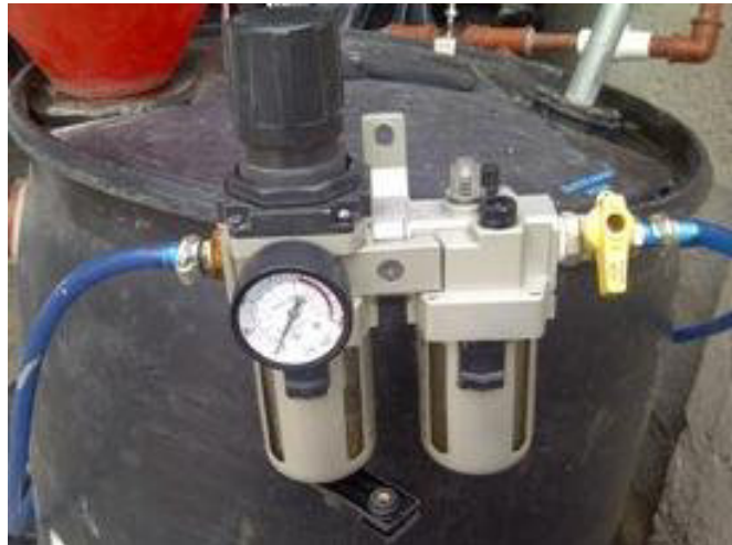
Figura 4. 25 Trampa de agua
