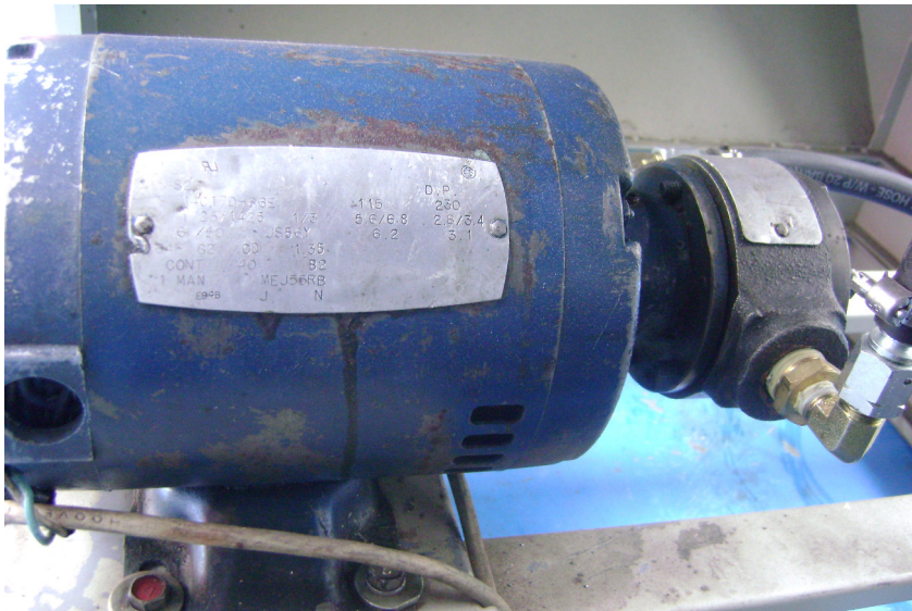
Figura. 4.6. Motor eléctrico con conexión a bomba hidráulica
