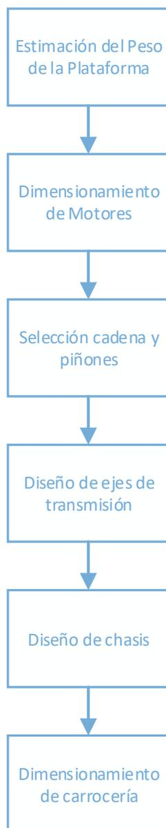
Figura 3.1 Proceso de diseño y selección de elementos mecánicos
