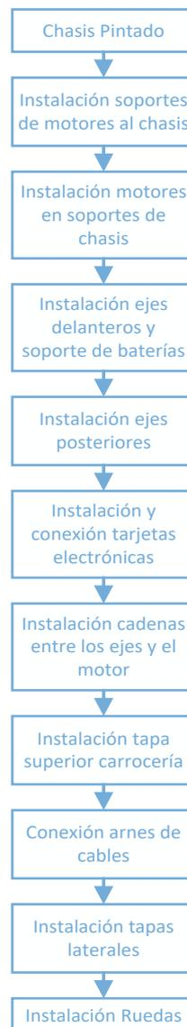
Figura 4.31 Proceso de ensamblaje plataforma
