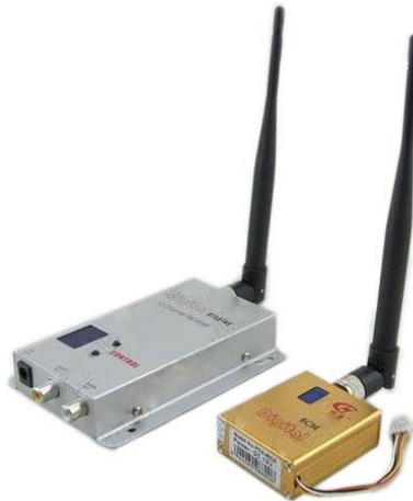
Figura 3.34 Módulos de Transmisión de Video
