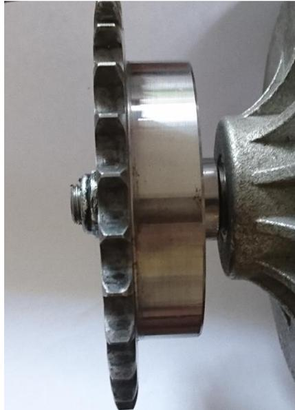
Figura 4.5 Eje del motor con piñón asegurado
