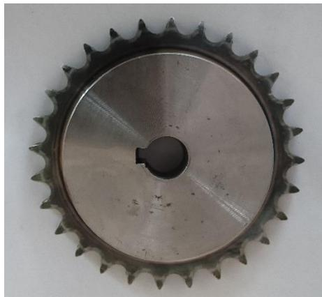
Figura 4.3 Piñón del Motor de 28 dientes
