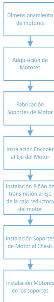
Figura 4.1 Proceso de Instalación de Motores
