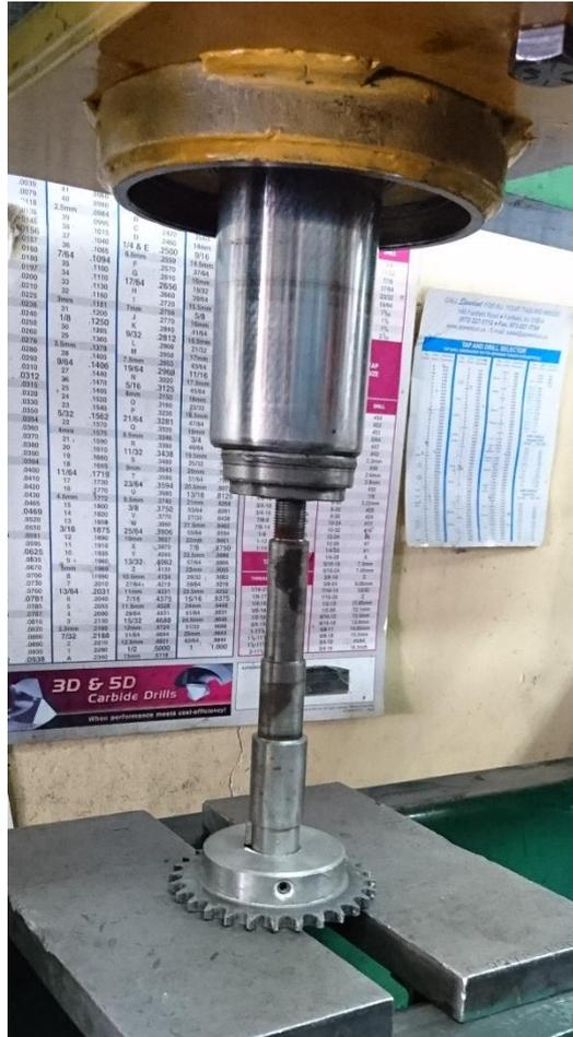
Figura 4.12 Piñón insertado en el eje
