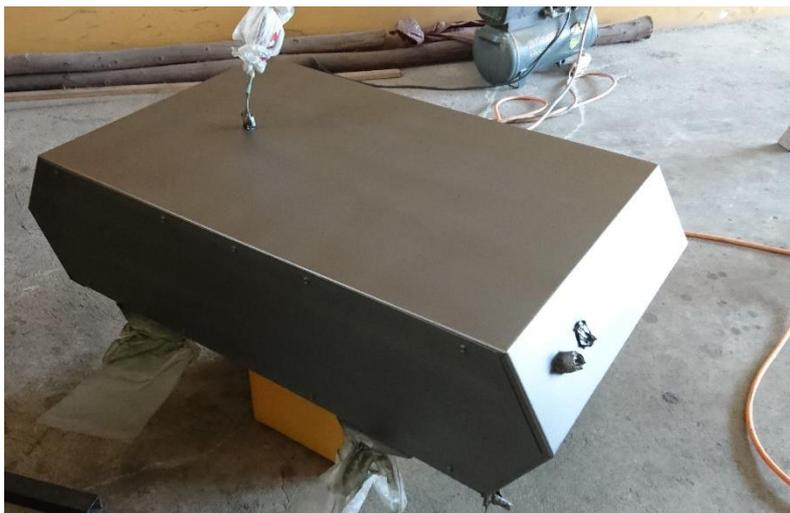
Figura 4.18 Carrocería capa final de pintura
