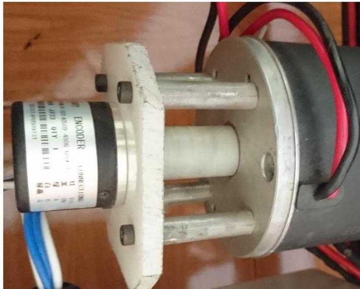
Figura 4.8 Motor con Encoder
