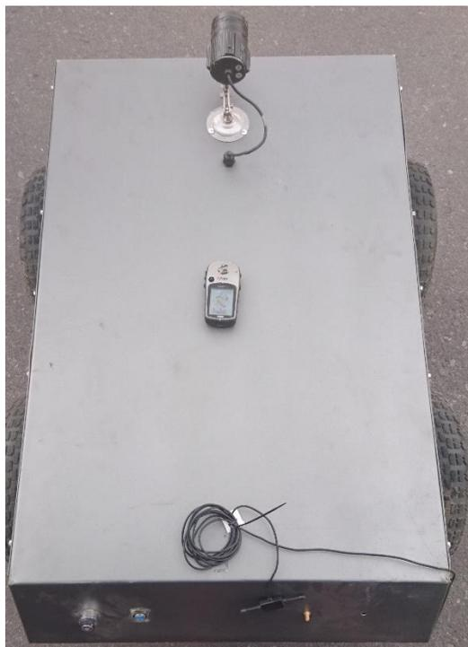
Figura 4.36 Plataforma con GPS instalado
