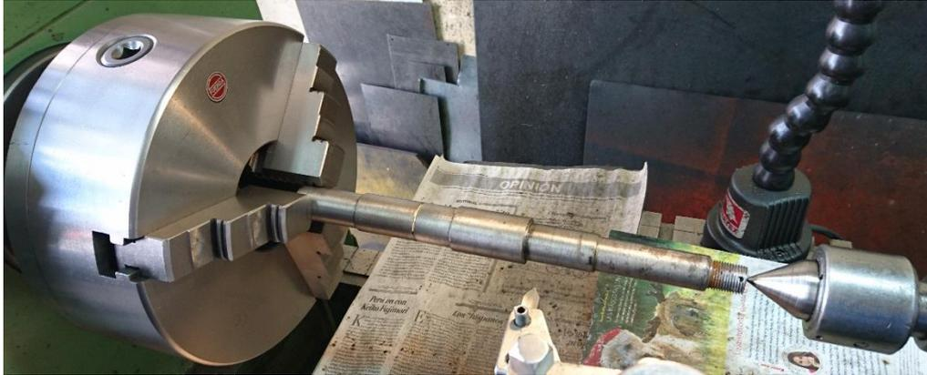
Figura 4.10 Eje maquinado en el torno
