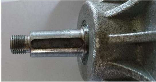
Figura 4.2 Eje Motor silla de ruedas
