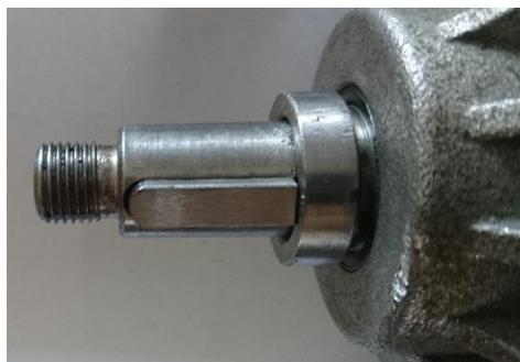
Figura 4.4 Fotografía Eje de Motor con chaveta y bocín.
