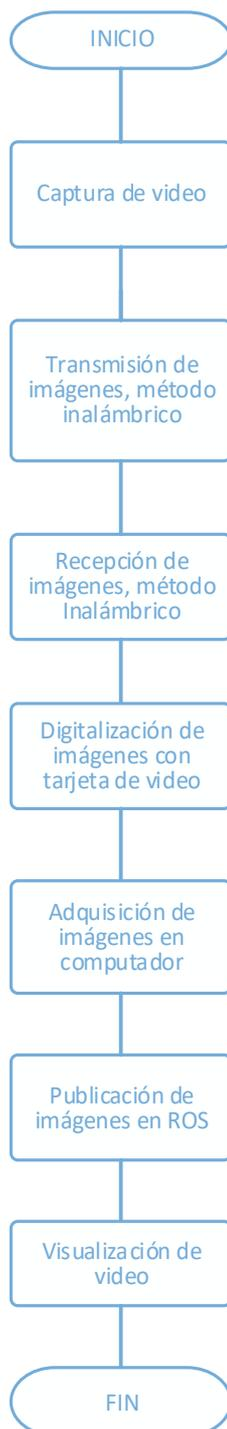
Figura 3.39 Proceso de adquisición de imagen
