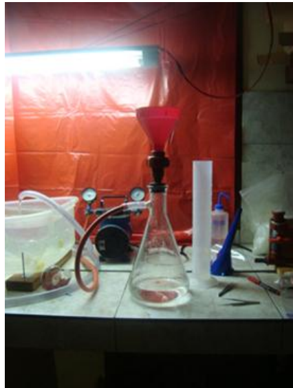
Figura 4. Sistema de filtración para nutrientes. El filtro se conformó de un embudo conectado a un tubo donde se ponía el filtro mientras una bomba empujaba el agua. Se filtró el agua de las diferentes profundidades de los puntos de muestreo la cual se congeló para el análisis posterior.
