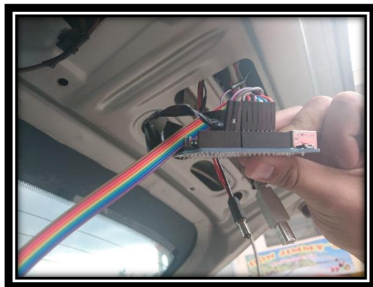
CONEXIÓN ARDUINO UNO EN LA CAJUELA
