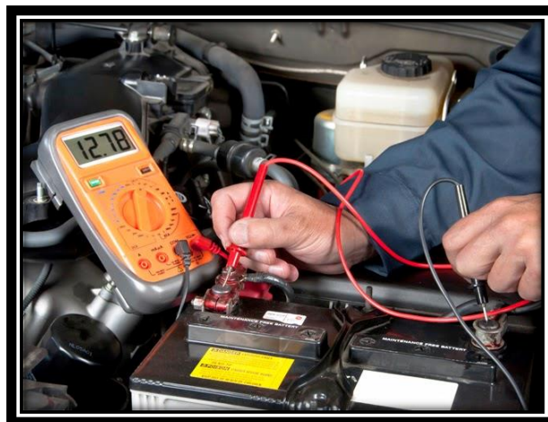
Figura 2.3 Medición de voltaje de batería en el vehículo
