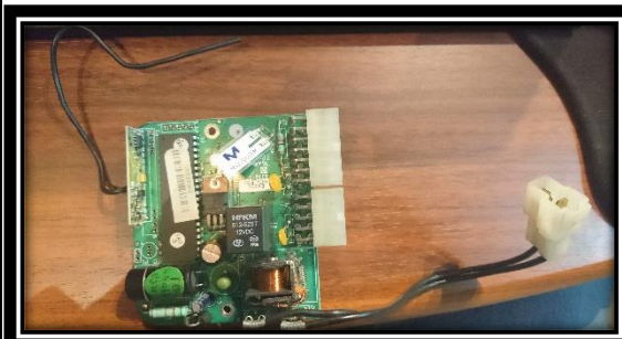
PARTES INTERNA DE MÓDULO DE ALARMA CHEVROLET
