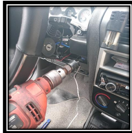
PERFORACIÓN DEL TABLERO DE INSTRUMENTOS PARA COLOCAR EL BOTÓN DE ENCENDIDO
