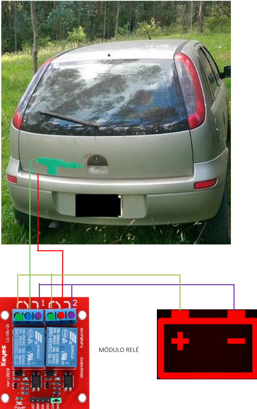
Figura 4.47 Diagrama de conexión y alimentación de la cajuela del vehículo con el módulo relé y el actuador. Fuente: Israel Cevallos
