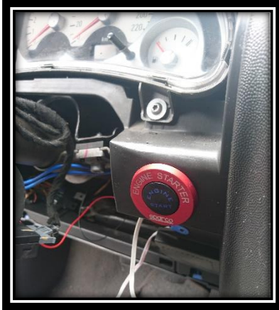
INSTALACIÓN Y PRUEBA DE BOTÓN DE ENCENDIDO
