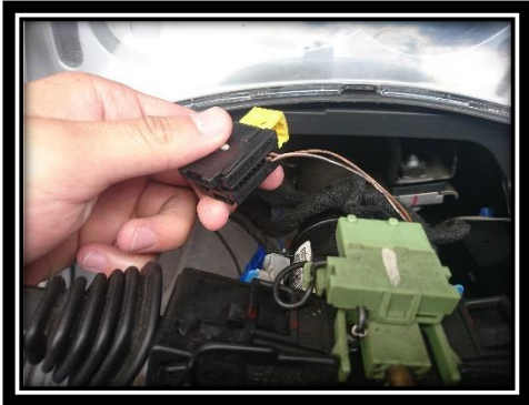
IDENTIFICACIÓN DE LOS CABLES DE LA BOCINA
