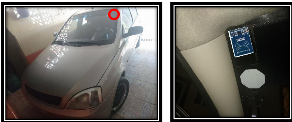
Figura 5.11 Prueba de apertura y cierre de puertas mediante NFC/RFID
