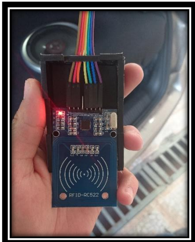
CONEXIÓN MÓDULO RFID CON ARDUINO UNO EN CAJUELA
