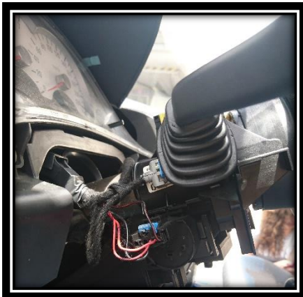
IDENTIFICACIÓN DE LOS CABLES DE IGNICIÓN
