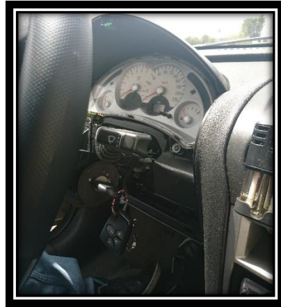
ELIMINACIÓN SWITCH DE ENCENDIDO
