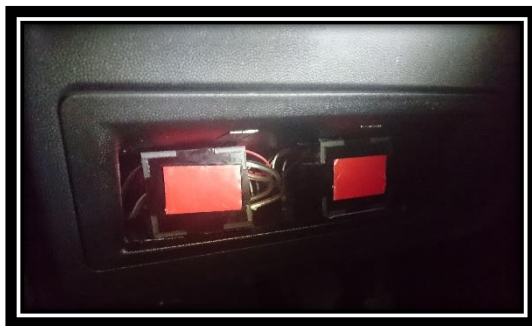
SUJECIÓN DE LAS CAJAS CON SUS RESPECTIVOS MÓDULOS EN GABETA DEL VEHÍCULO
