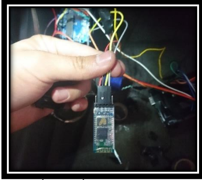
CONEXIÓN MÓDULO BLUETOOTH HC-05 A ARDUINO UNO DE PUERTAS
