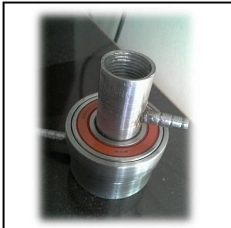
**Figura 5.4 Acople Neumático giratorio.**
