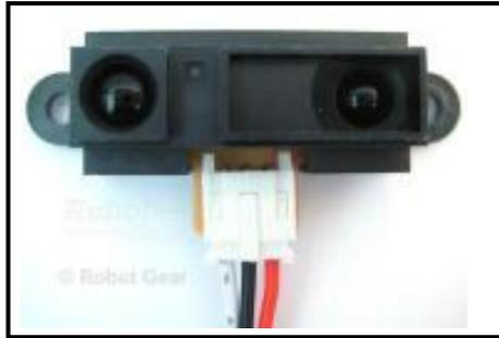
**Figura 4.4 Fotografía del sensor SHARP GP2Y0A21YK0F.**
