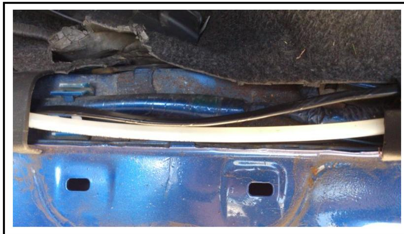
**Figura 5.18 Fotografía de la manguera oculta en la barredera del vehículo.**
