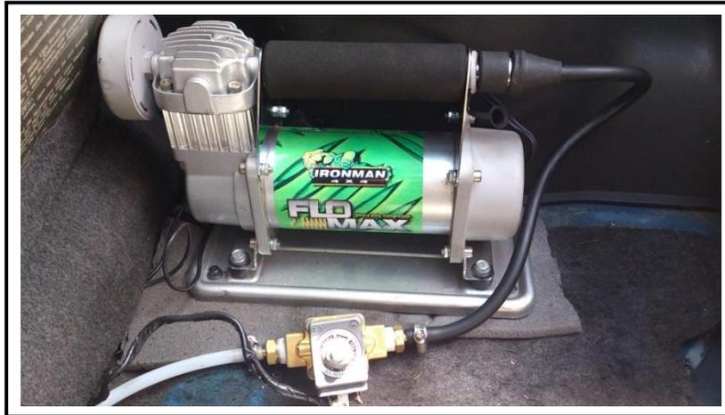
**Figura 5.19** Fotografía de la conexión entre el compresor y la electroválvula.
