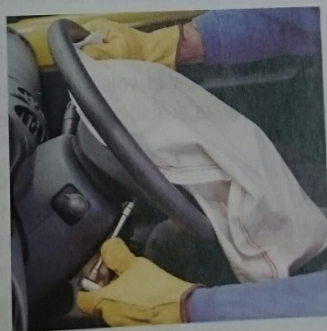
Aflojamiento de los tornillos de fijación
