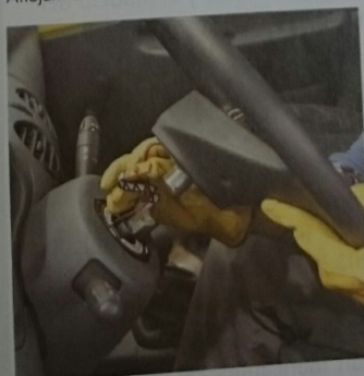
Extracción del volante
