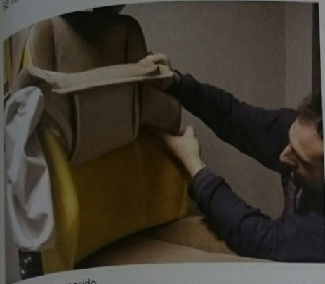
Extracción del guarnecido
