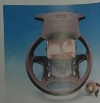
Disposición del airbag de conductor en el volante
