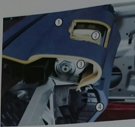
Módulo airbag de acompañante seccionado
