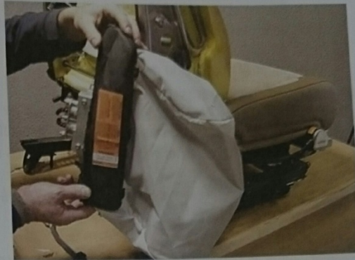
Extracción del módulo airbag
