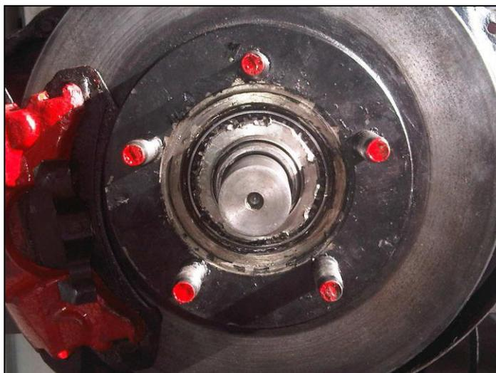
Figura 5.8 Fotografía real armado el conjunto de disco
