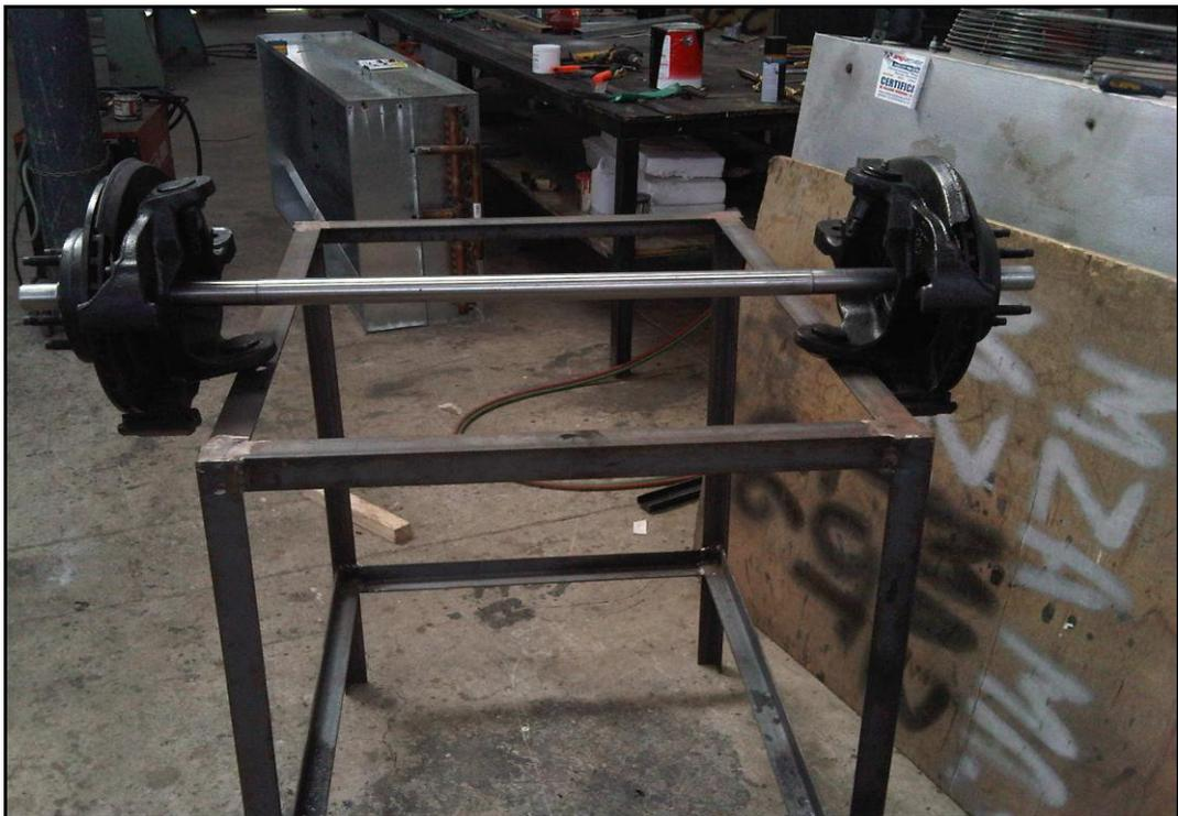
Figura 7.17 Porta discos, discos y el eje de transmisión montados en la estructura.
