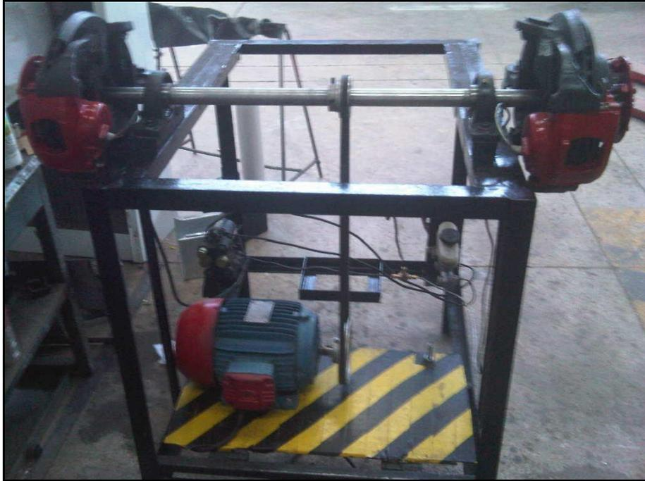
Figura 7.24 Ajuste de motor con la base que se inclina para el ajuste de banda.
