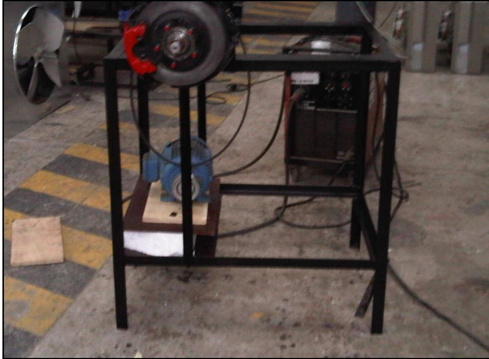
Figura 7.22 Instalación de soportes debajo de porta discos para frenar la vibración excesiva.
