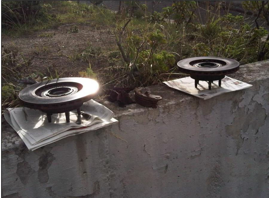
Figura 7.10 Discos de freno y pastillas.
