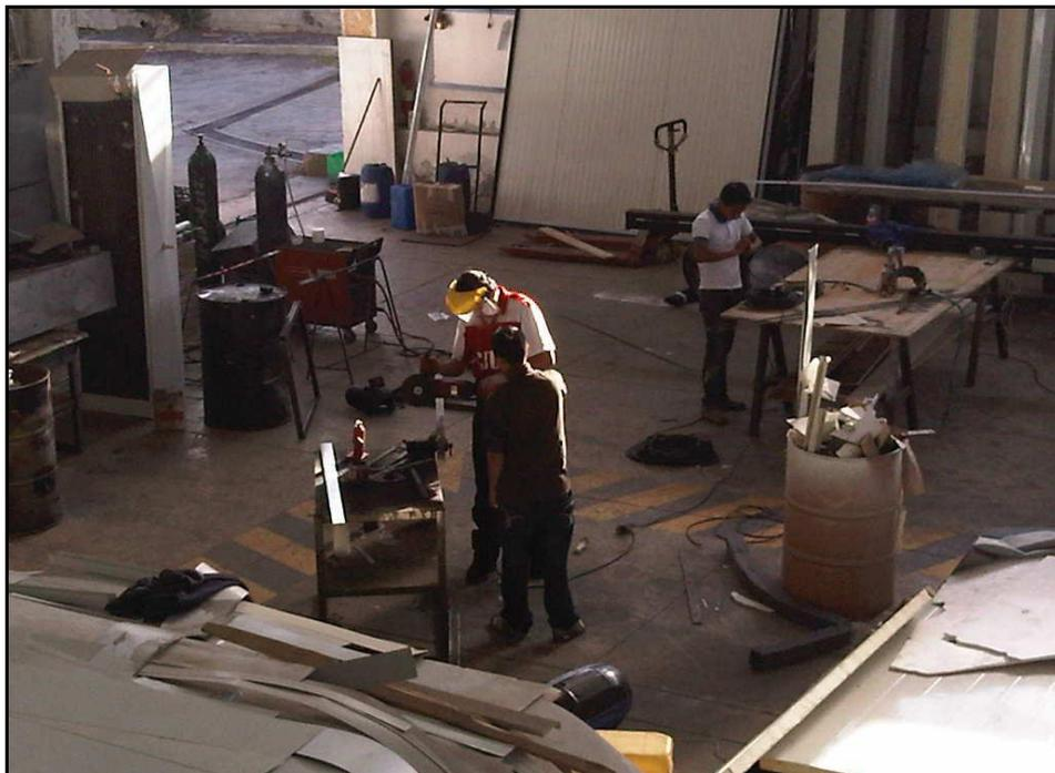
Figura 7.11 Comienzo de la estructura base. Corte de fierro ángulo para soldar y armar la estructura a medida.
