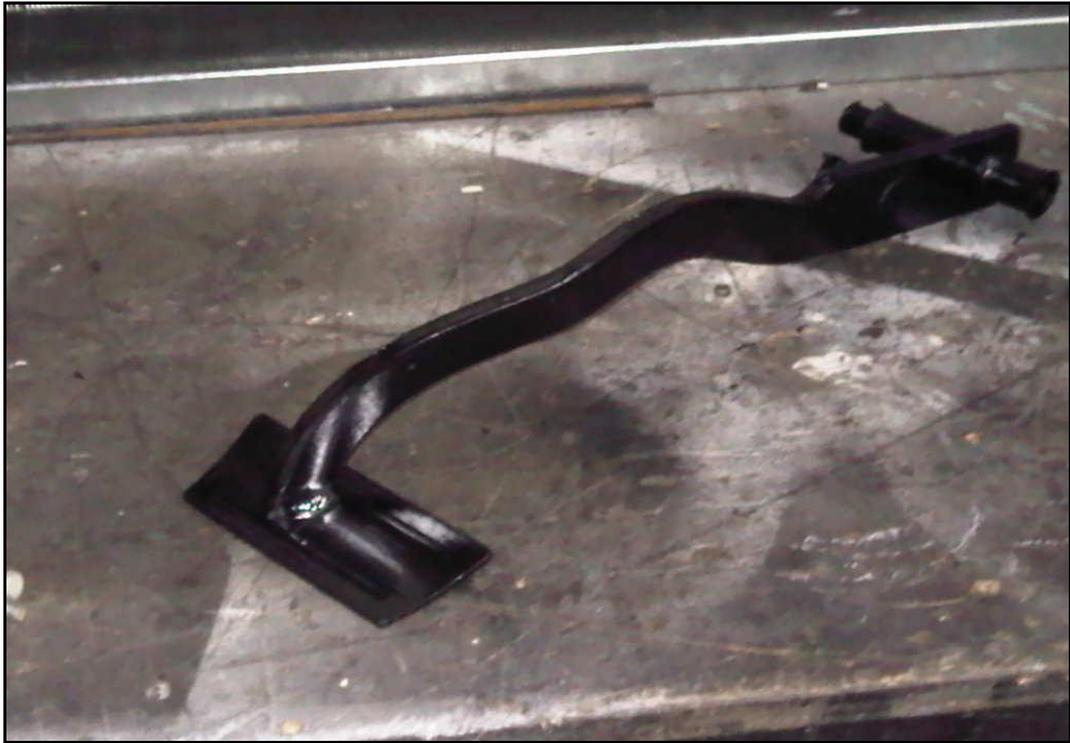
Figura 7.14 Pedal de freno de un vehiculo automático.
