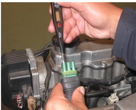
Gráfico No.- 3.31 Verificación de la Tierra del Sensor (MAP)
