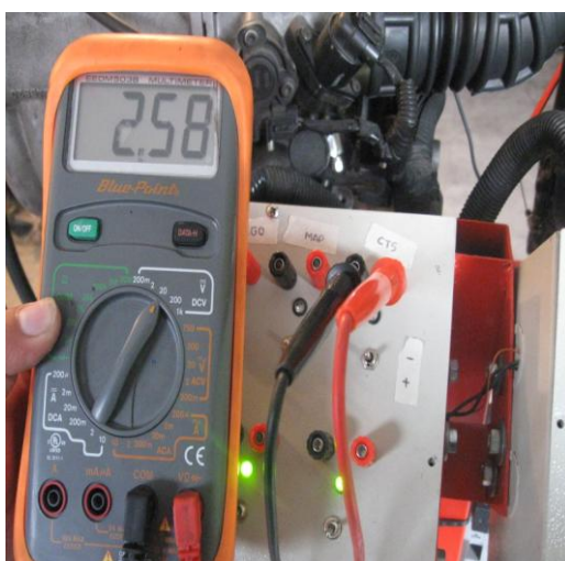
Gráfico No.- 3.18 Verificación del Voltaje de Retorno Sensor de Temperatura
