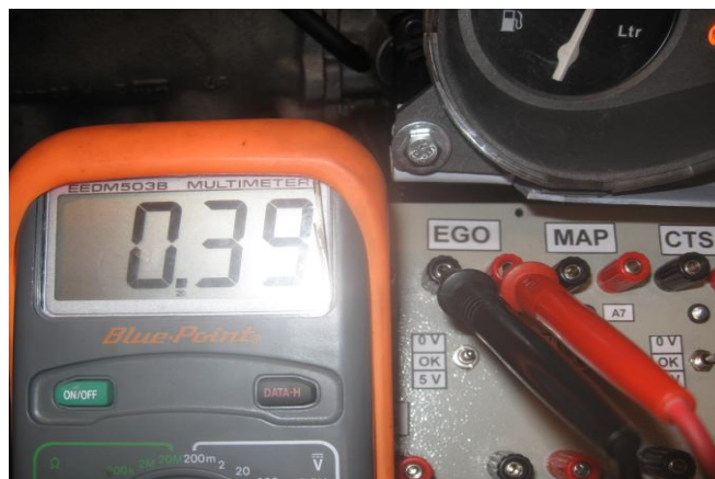
Gráfico No.- 3.25 Verificación del Voltaje de Retorno Sonda
