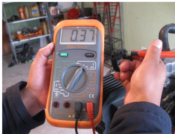
Gráfico No.- 3.23 Verificación de Voltaje de Referencia Sonda Lambda
