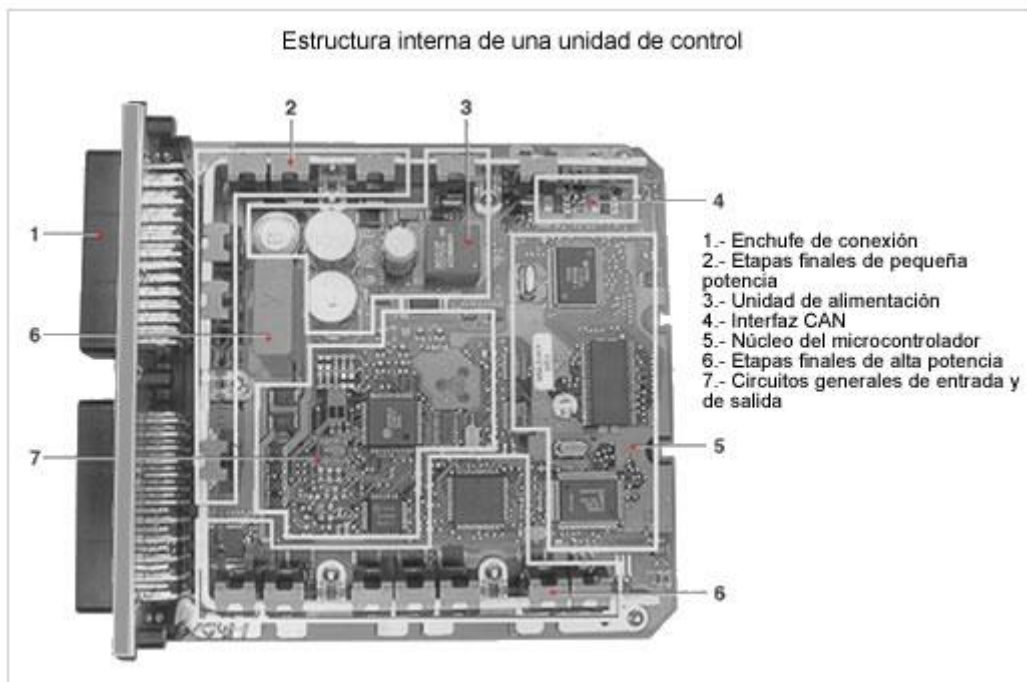
Gráfico No.- 2.1 Estructura Interna de una unidad de Control 14
