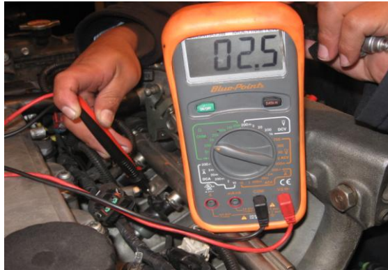
Gráfico No.- 3.41 Verificación Resistencia Eléctrica de los Inyectores
