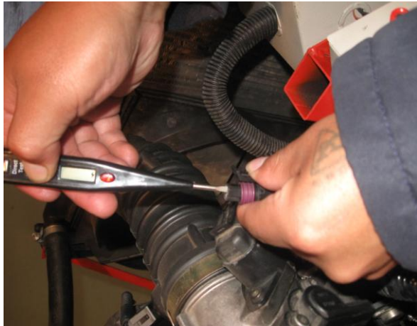
Gráfico No.- 3.27 Verificación de la Tierra (TPS)
