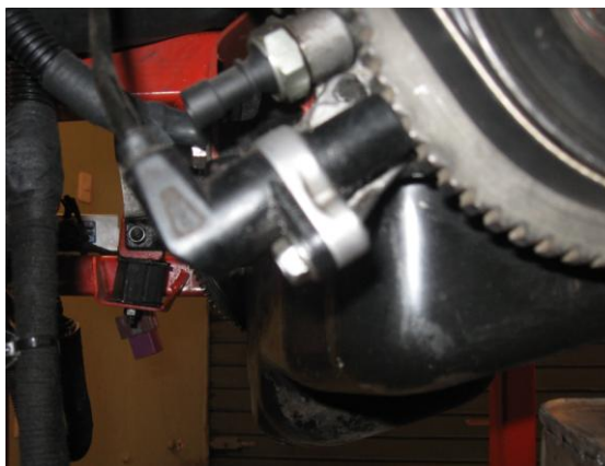
Gráfico No.- 3.40 Verificación de la Distancia y Posición Angular
