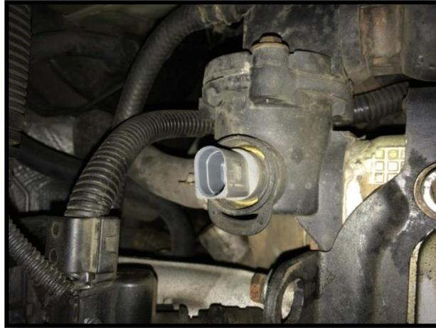
**Figura 3.** Sensor de Temperatura del refrigerante
