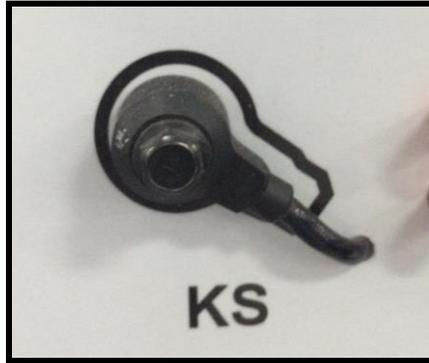
**Figura 11.** Sensor de detonación
