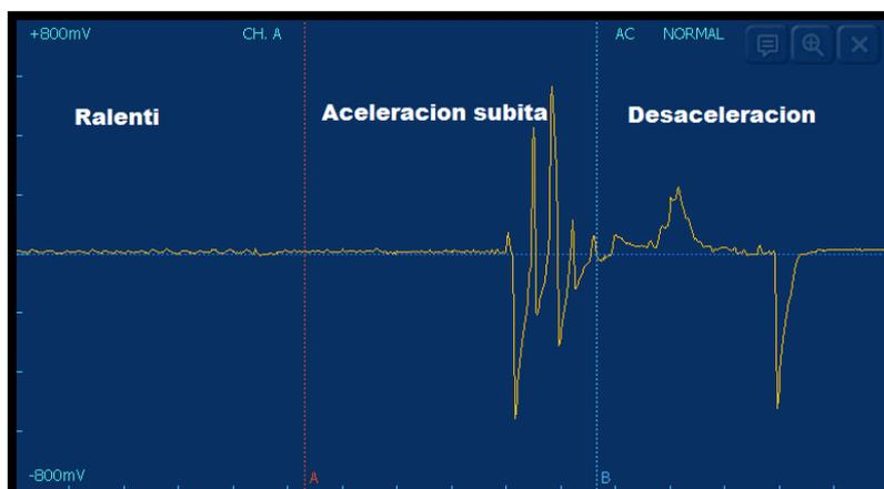
**Figura 43.** Gráfica del sensor de oxígeno trasero
