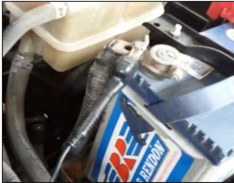
Figura 16. Conexión del terminal negativo del osciloscopio a tierra
