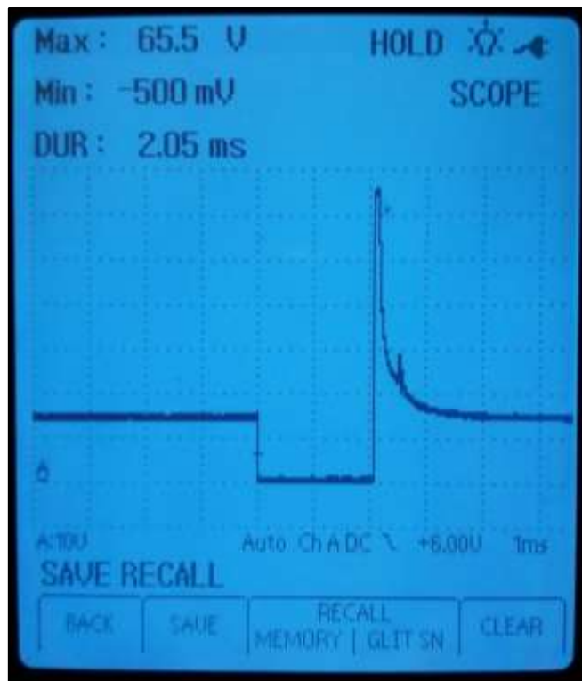
Figura 19. Señal del inyector a 2500 rpm
