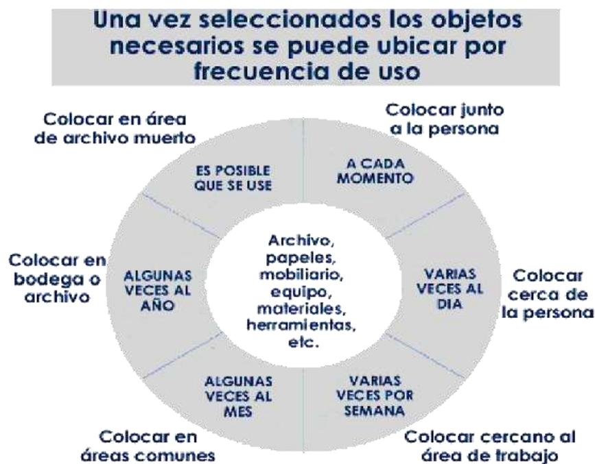
Figura 5. Diagrama de frecuencia y secuencia de uso de elementos}
