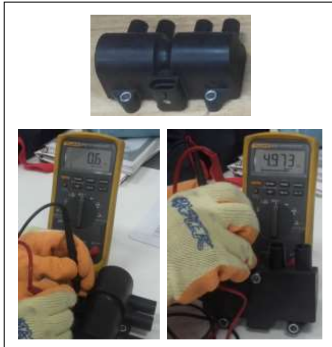
Figura 68: Medición de resistencias del primario y secundario de la bobina Delphi
