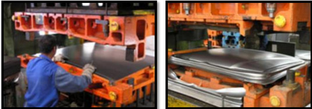
**Figura 2.48** Proceso manual de montaje de chapas para prensa
