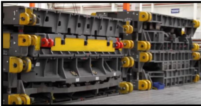
**Figura 2.51** Moldes montables y desmontables para prensa de autopartes
