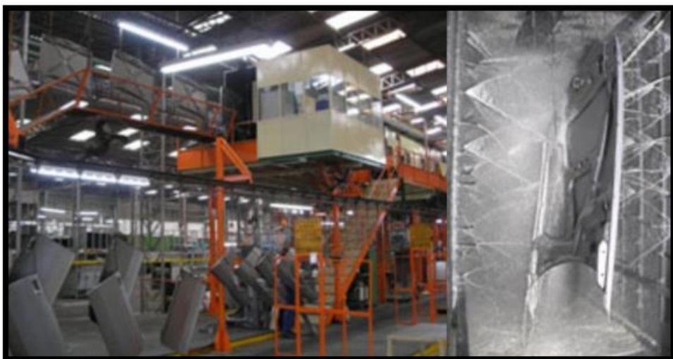
**Figura 2.57** Desengrasé y lavado de partes
