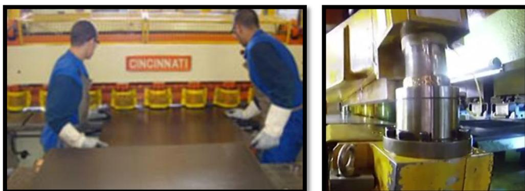
**Figura 2.47** Proceso de cortado de láminas
