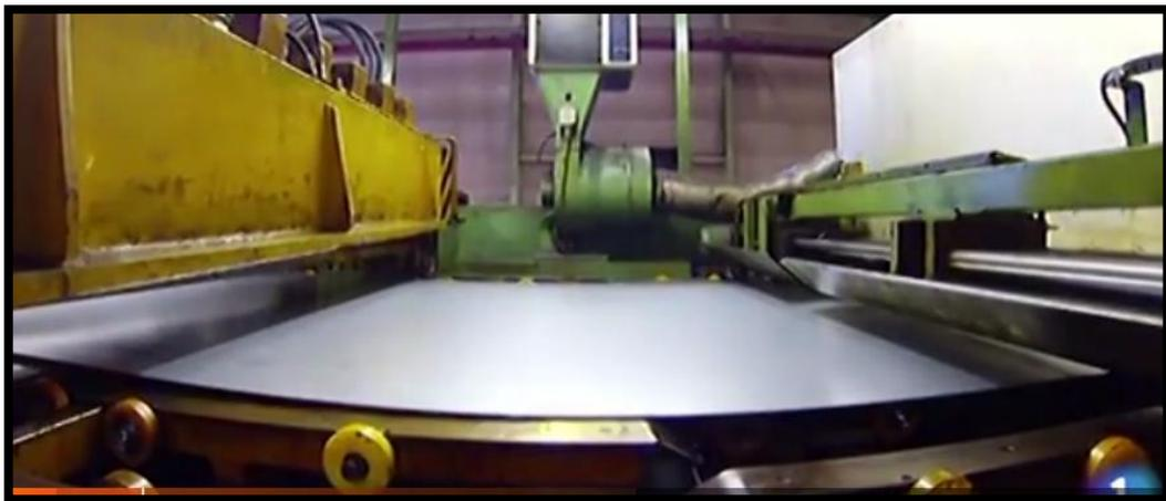
**Figura 2.45** Rodillos de láminas para enderezar
