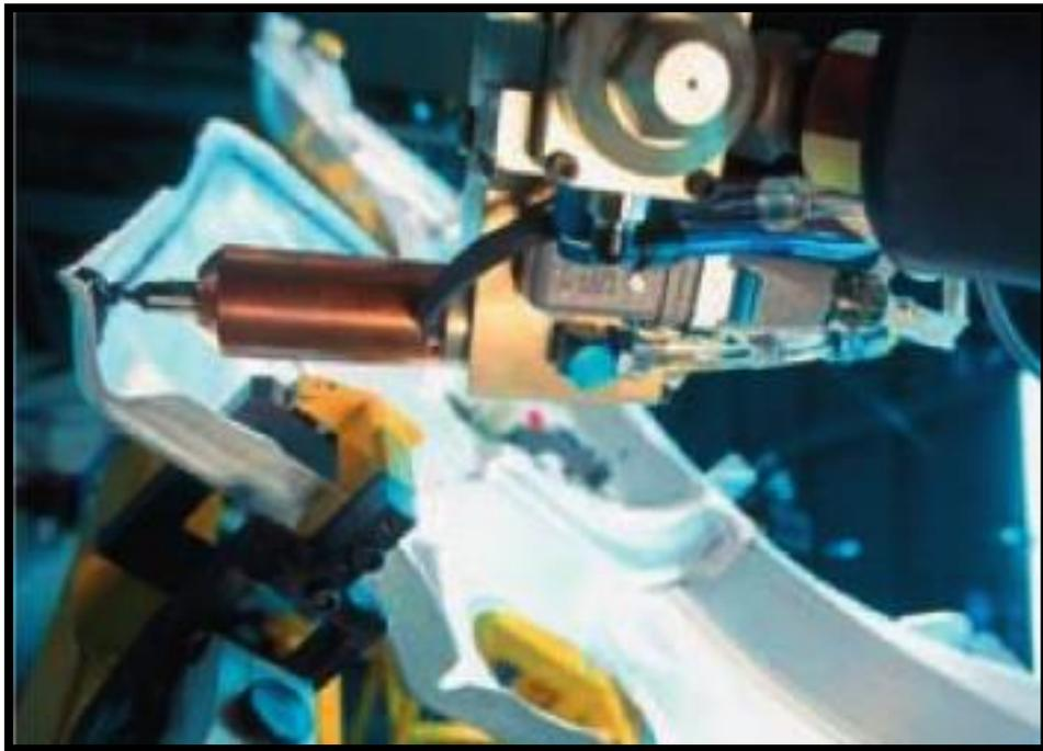
**Figura 2.40** Sellantes mediante automatización
