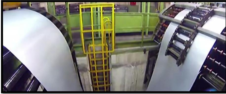
**Figura 2.44** Paso de chapa a 90 grados para formar la lámina plana
