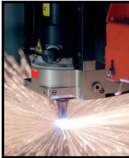
**Figura 2.32** Corte de chapa mediante láser
