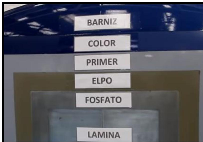
**Figura 2.59** Proceso pintura para carrocerías
