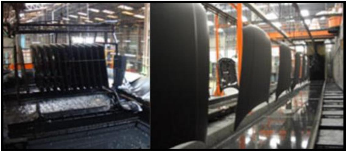
**Figura 2.58** Proceso de pintura anticorrosiva
