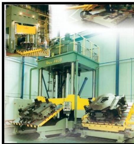
**Figura 2.23** Prensa de columna
