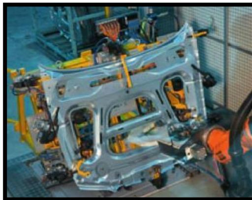
**Figura 2.34** Capot en proceso de fabricación
