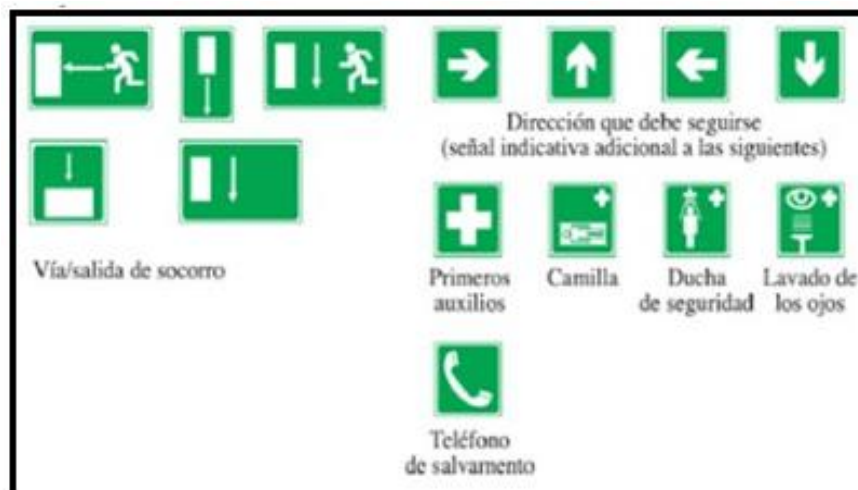
Figura 1.11: Señales de salvamento
