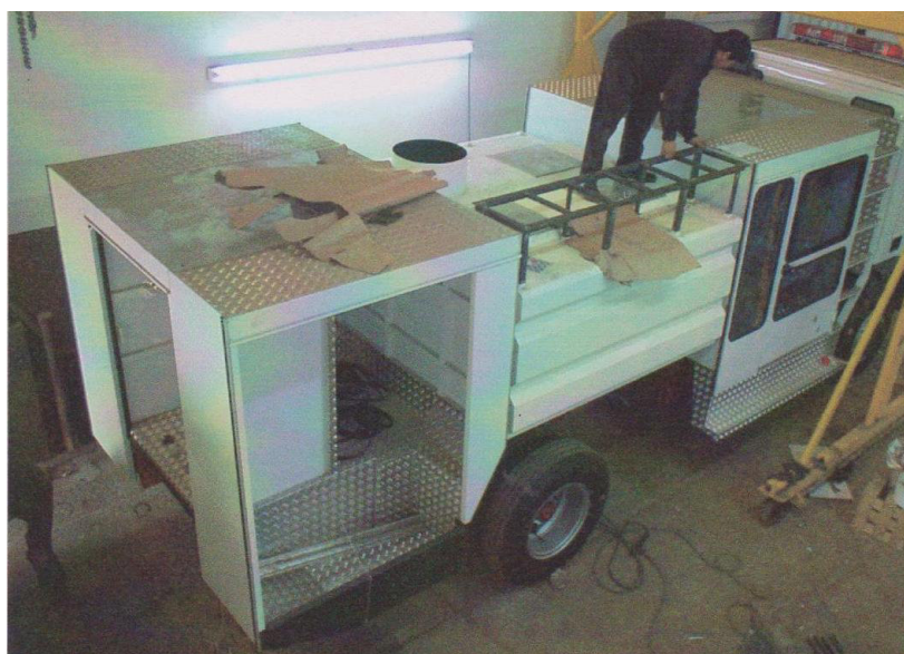
Figura 2.3. Tanque visto de autobomba.
