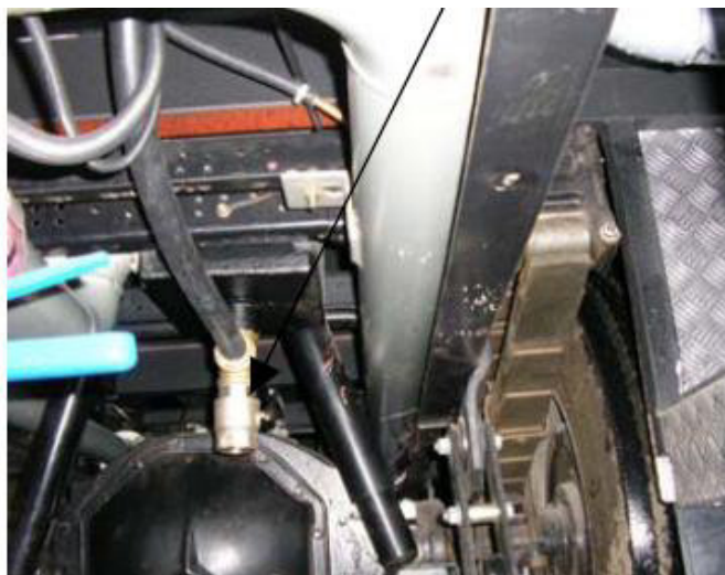
Figura 2.5. Válvula de drenaje
