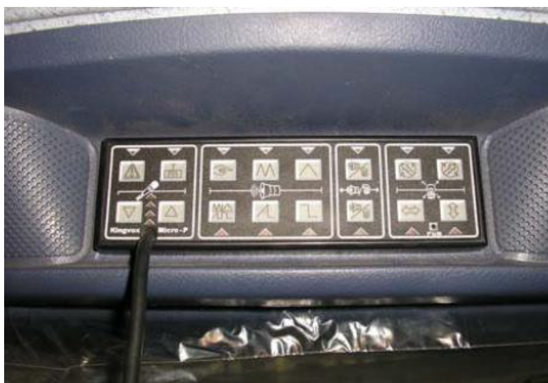
Figura 3.17. Tablero de comando de la baliza.
