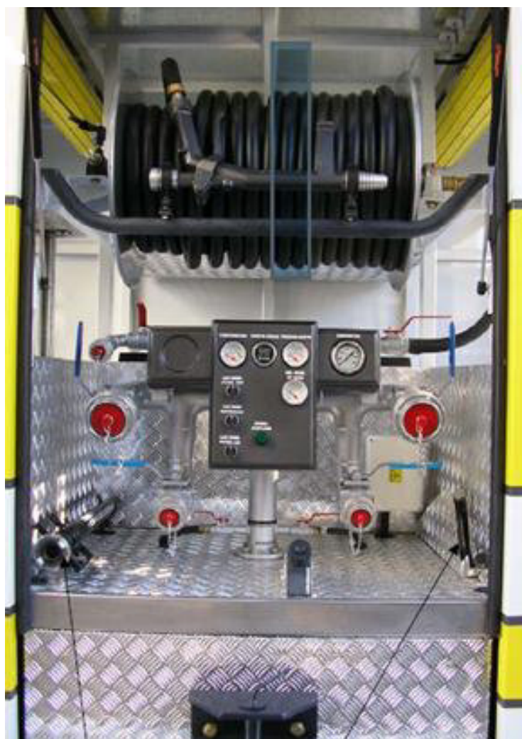
Figura 3.9. Habitáculo bomba hidráulica y accesorios.
