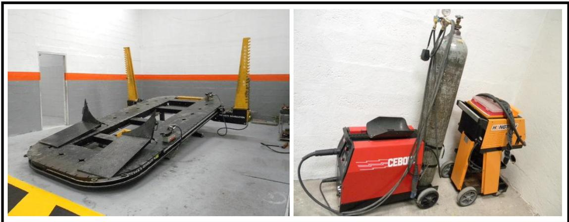
**Figura 1.3 Cama de templado y correcciones; sueldas especiales**
