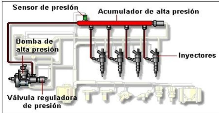
Figura 2.8 - Circuito de alta presión
