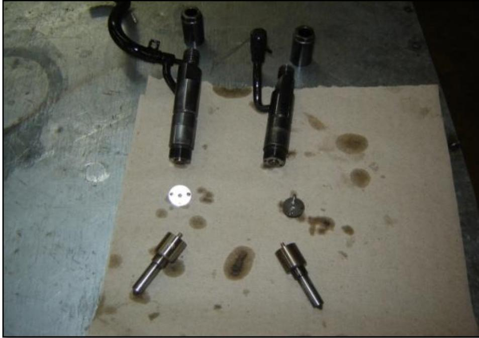
Figura 3.2 – Elementos – Inyectores
