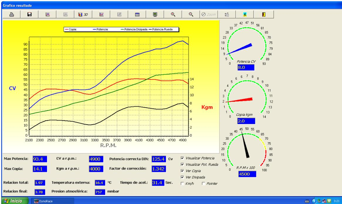
Figura 3.18 – Prueba Dinamómetro sin Algae-x
