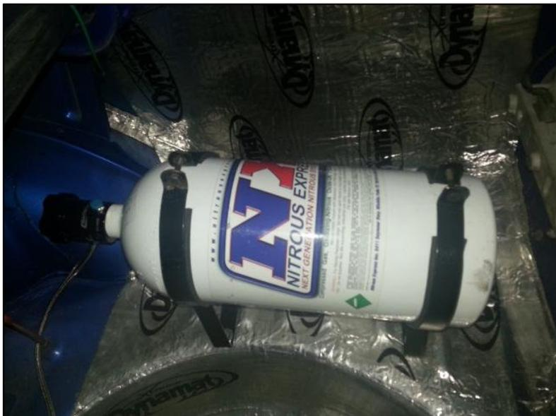
Figura 3.23. Cilindro de N<sub>2</sub>O instalado.
