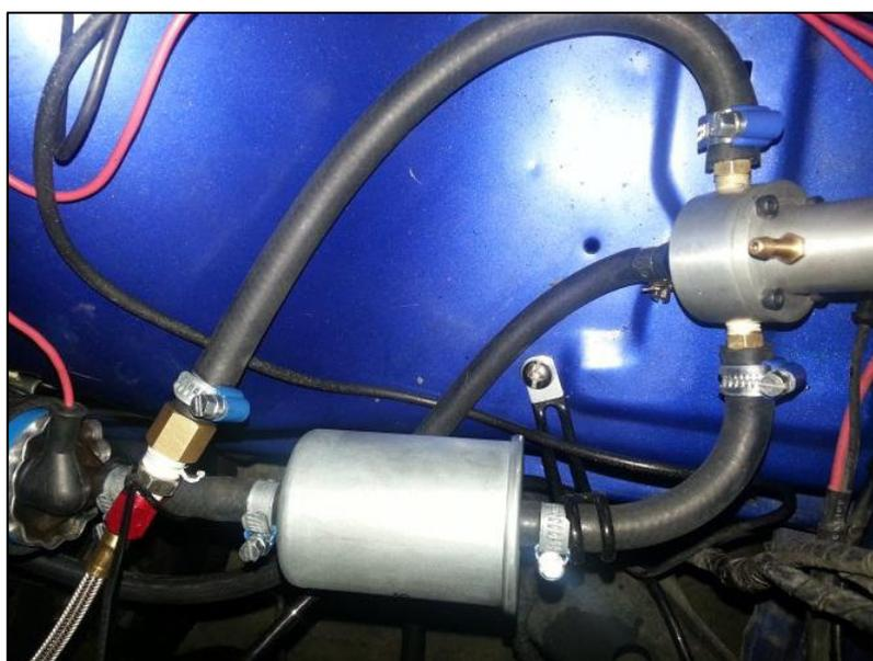
Figura 3.12. Sistema de Combustible para Inyección de N<sub>2</sub>O.
