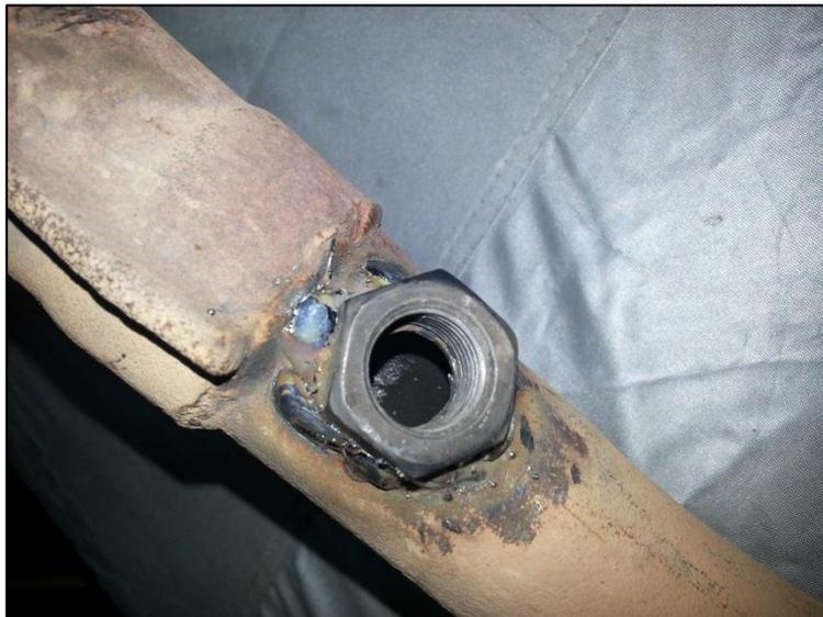
Figura 4.10. Adaptación de tuerca al colector de escape.
