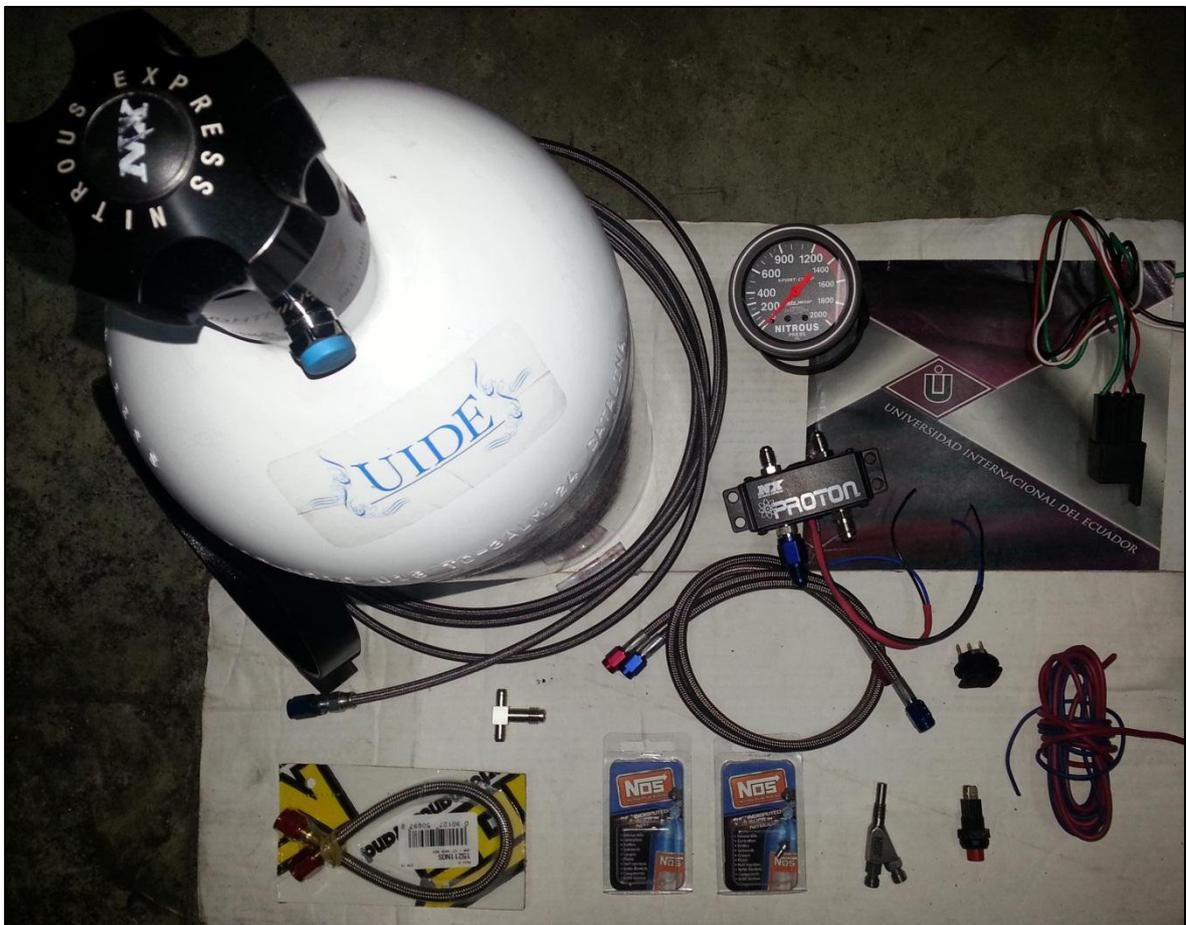
Figura 2.7. Equipo de Óxido Nitroso seleccionado para el proyecto.
