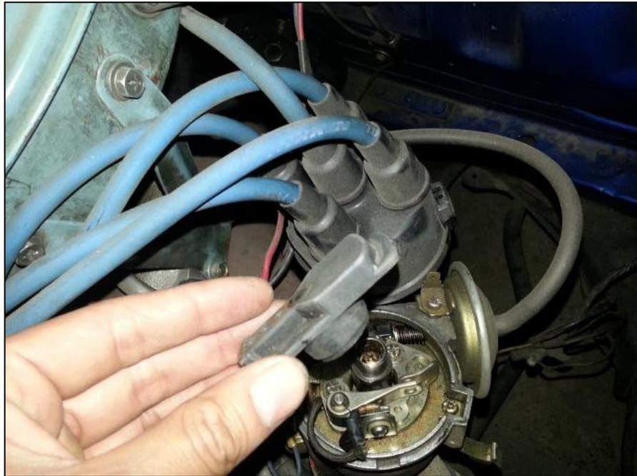
Figura 3.1. Encendido por Ruptor - Distribuidor Original Nissan L16
