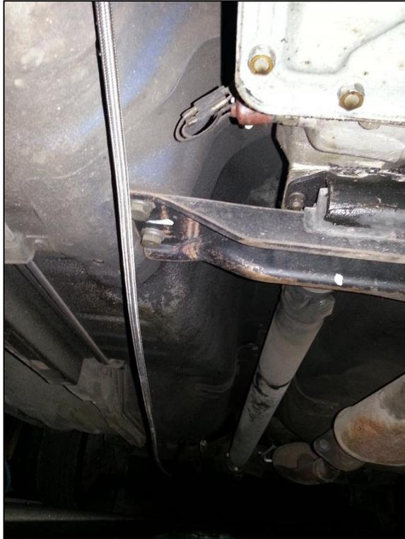
Figura 3.24. Manguera mallada bajo el vehículo.
