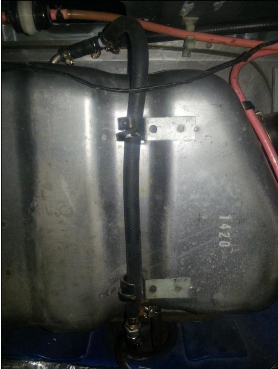
Figura 3.13. Adaptación de Línea para Retorno de Combustible al Tanque.
