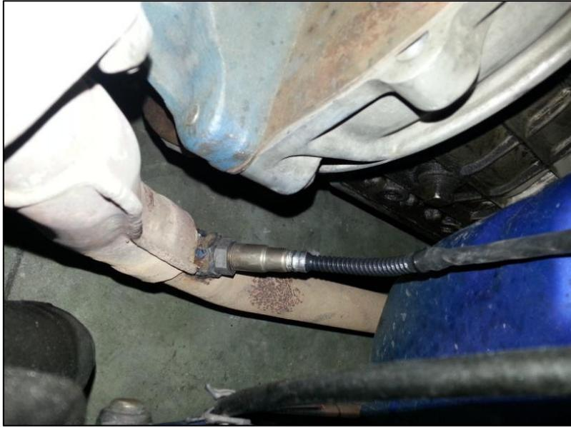
Figura 4.11. Sensor de oxígeno instalado en el colector de escape.
