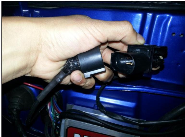
Figura 4.12. Conector del sensor de oxígeno y lector de factor lambda.
