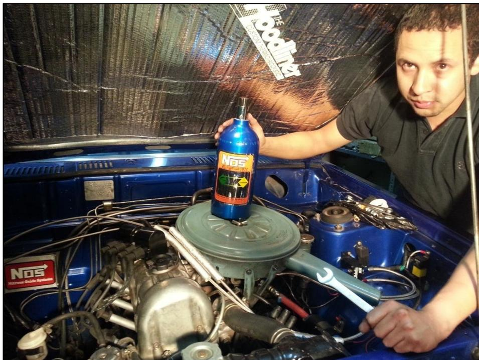
Figura 3.31. Sistema Instalado al Motor Nissan L16.
