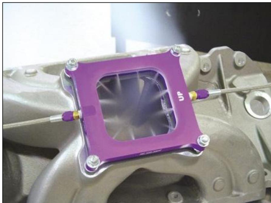
Figura 2.19. Placa de Inyección marca ZEX, en funcionamiento.
