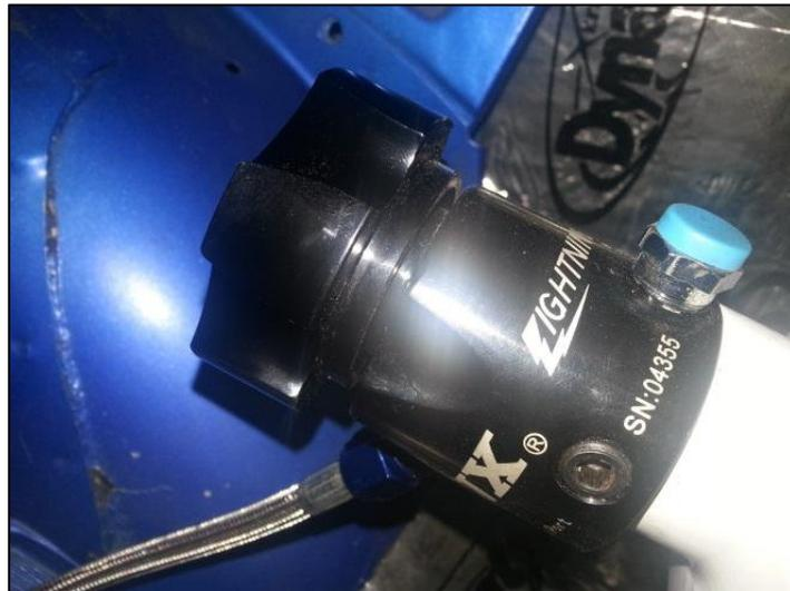
Figura 2.9. Válvula Reguladora de Flujo – con dispositivo de seguridad.
