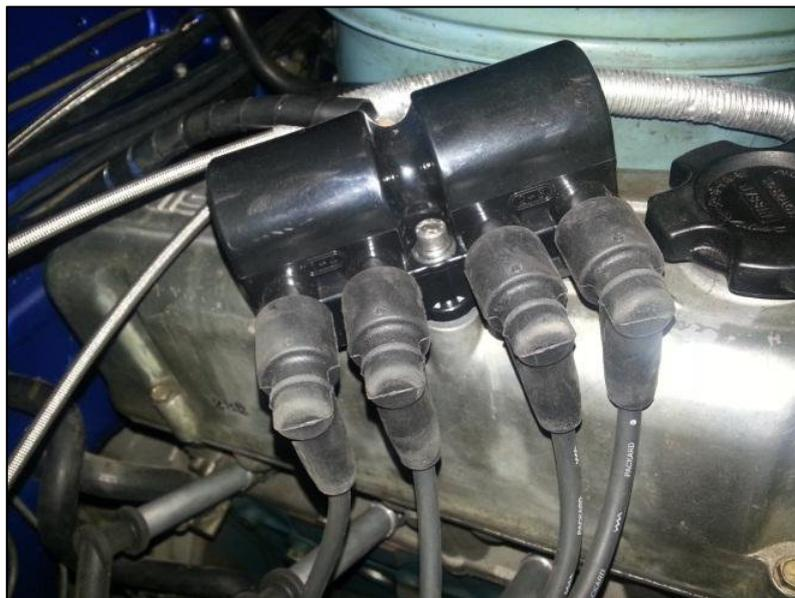
Figura 3.9. Bobina de Encendido DIS.
