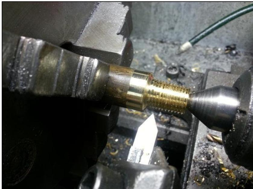
Figura 3.18. Fabricación de rosca ajustable al múltiple de admisión.
