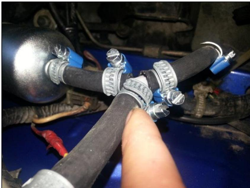
Figura 3.11. Acople Tipo “Y” – Derivación de Línea de Combustible.
