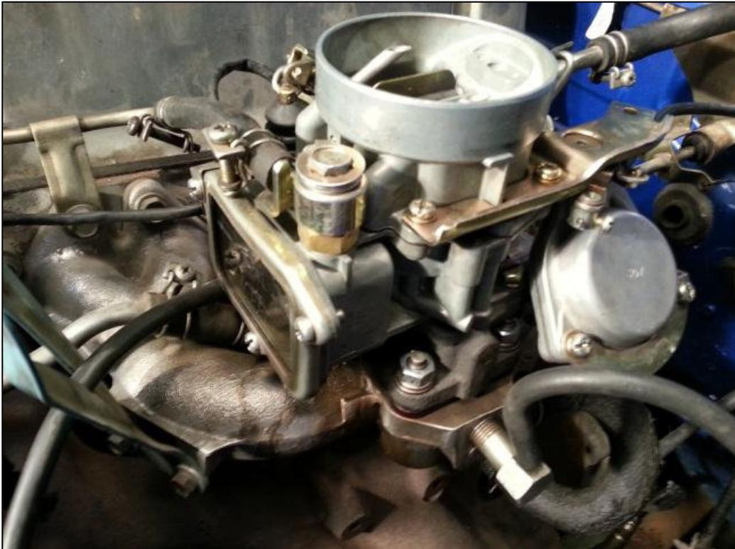
Figura 2.2. Carburador Nikki – doble vénturi
