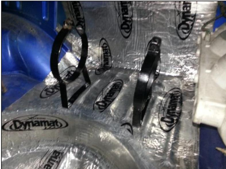
Figura 3.22. Instalación de soportes sujetadores del cilindro.
