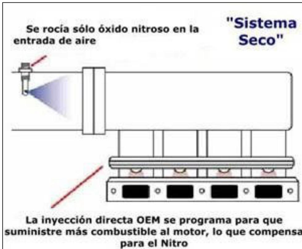
Figura 2.17. Sistema de Óxido Nitroso Seco.
