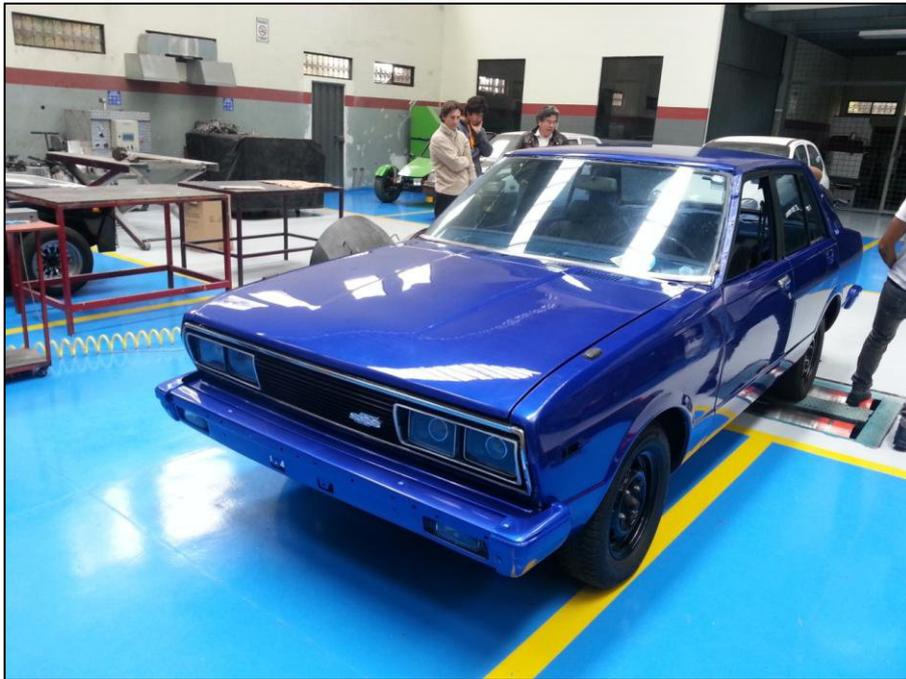
Figura 4.2. Vehículo montado sobre los rodillos del dinamómetro.
