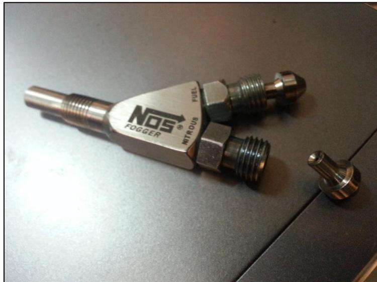
Figura 3.28. Inyector de  $N_2O$  y Jets.
