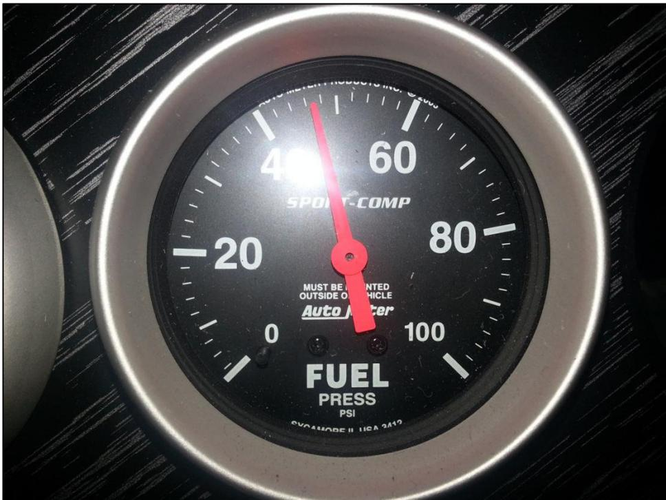
Figura 3.15. Manómetro de presión de combustible.
