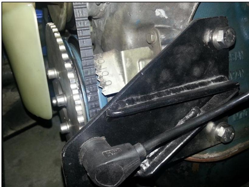
Figura 3.5. Montaje del Soporte de sensor CKP.
