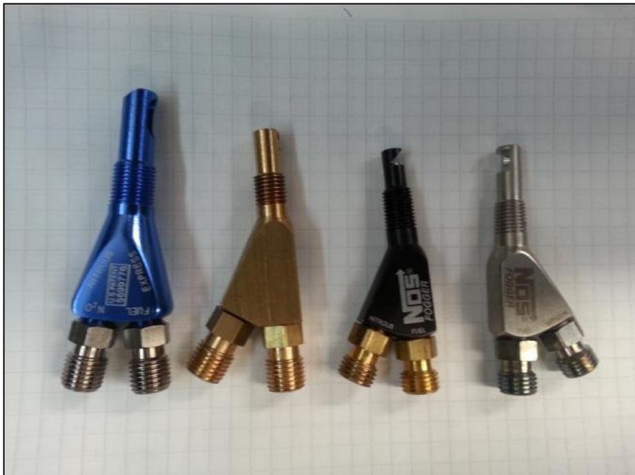
Figura 2.16. Inyectores de  $N_2O$ .
