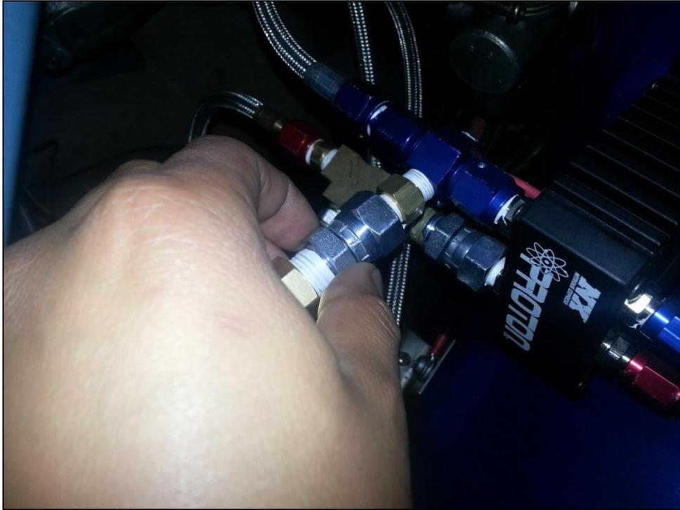
Figura 3.14. Acople tipo "T" – Conexión a manómetro de presión.
