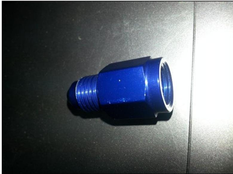
Figura 3.26. Filtro utilizado antes de la electroválvula.
