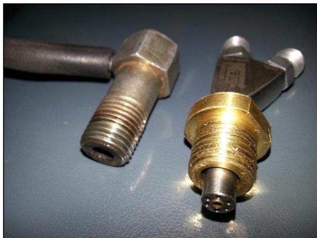
Figura 3.20. Prueba de Adaptación del Inyector al Acople.
