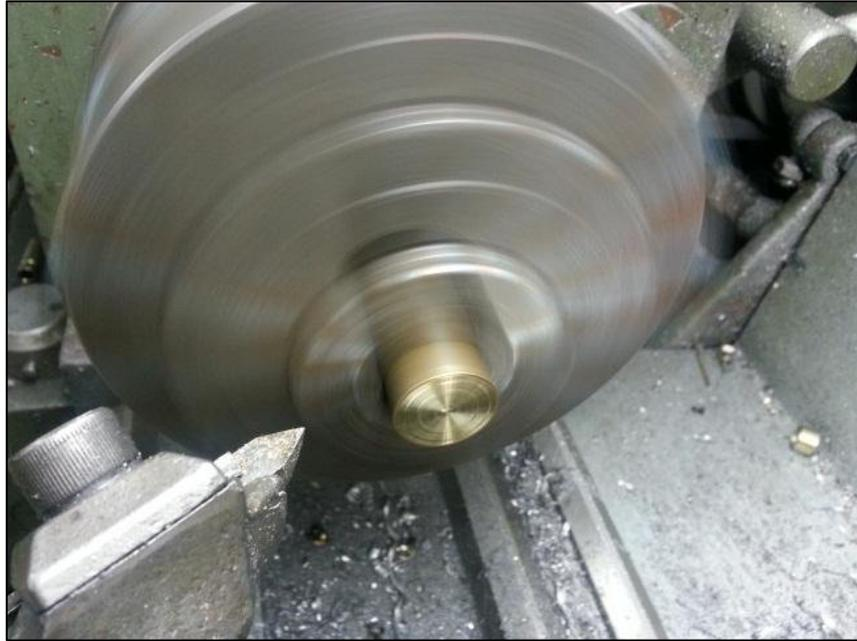
Figura 3.17. Torneado de Acople Adaptador de Inyector.
