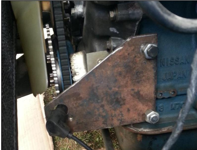
Figura 3.4. Platina para soporte de sensor CKP.
