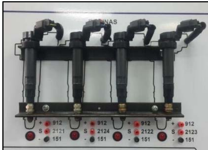
Figura 27. Instalación de bobinas de encendido Autor: Julio Obregón
