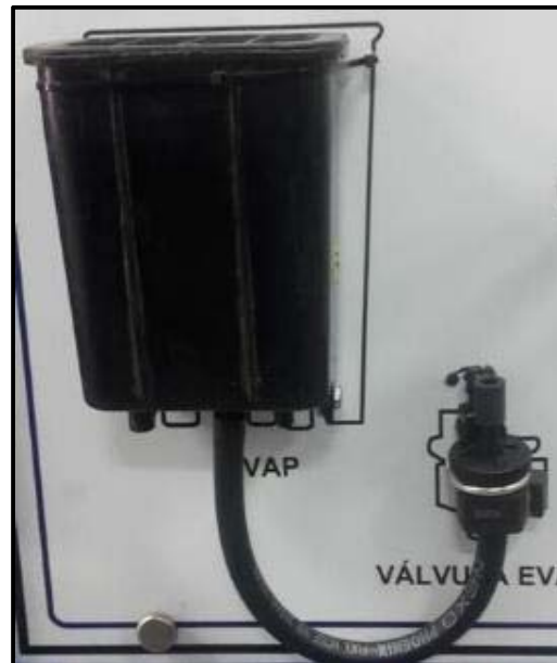
Figura 41. Instalación de válvula EVAP Autor: Julio Obregón
