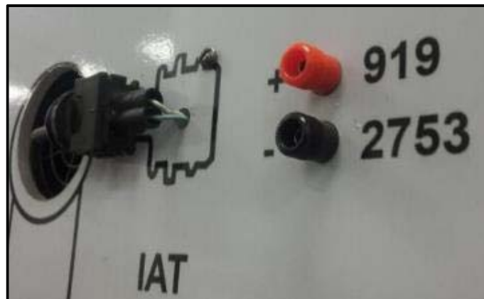
Figura 20. Instalación de sensor IAT Editado por: Julio Obregón
