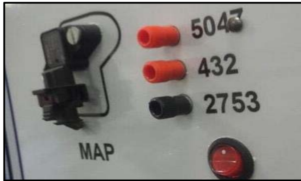
Figura 21. Instalación de sensor MAP Autor: Julio Obregón
