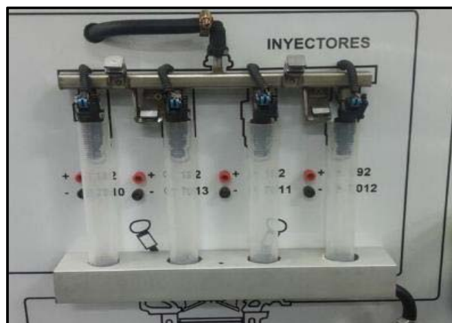
Figura 36. Instalación de los inyectores Autor: Julio Obregón
