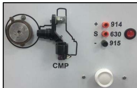
Figura 25. Instalación de sensor CMP Autor: Julio Obregón
