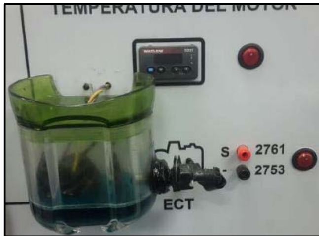
Figura 29. Instalación de sensor ECT Editado por: Julio Obregón
