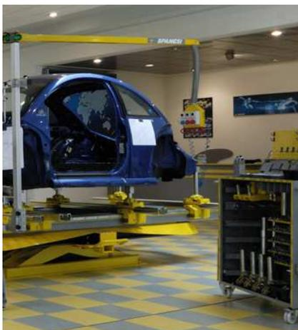
**Figura 3.20** Medición en bancada
