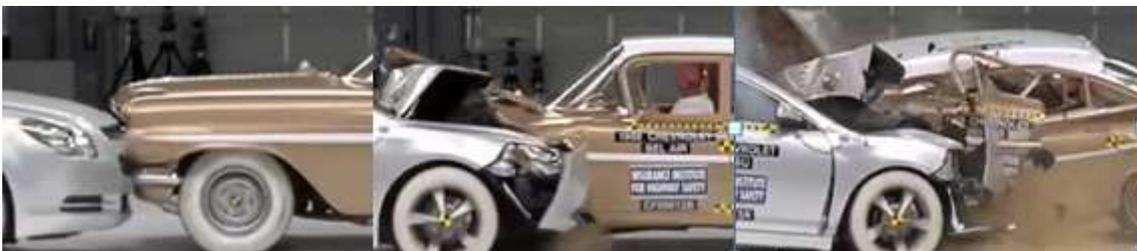
**Figura 1.7** Prueba de impacto Chevy Malibu 2009 vs Bel Air 1959
