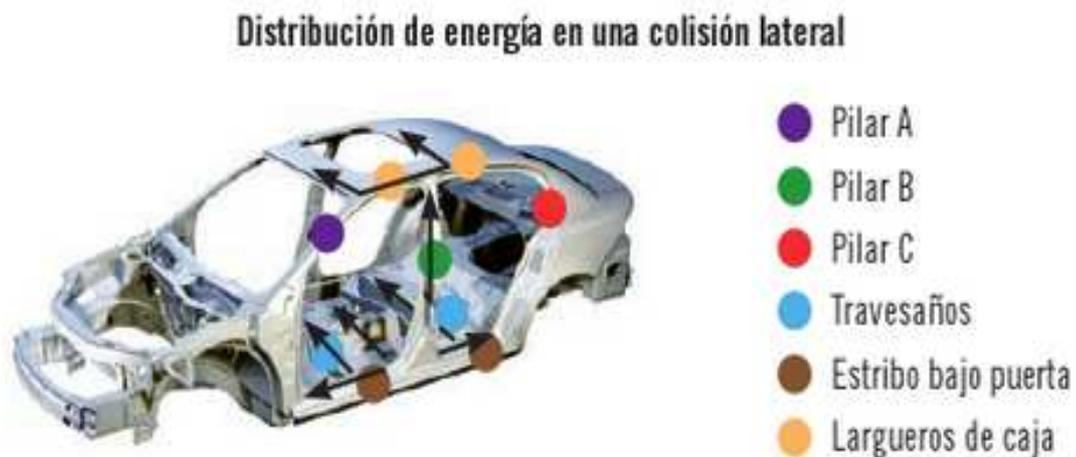
**Figura 1.9** Distribución de energía en una colisión lateral
