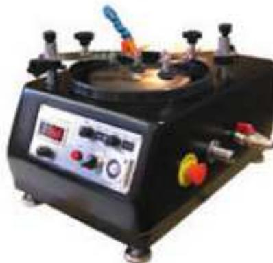
**Figura 2.7** Maquina de pulido abrasivo
