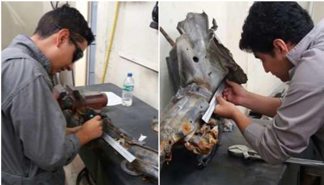
**Figura 4.6** Extracción de las probetas
