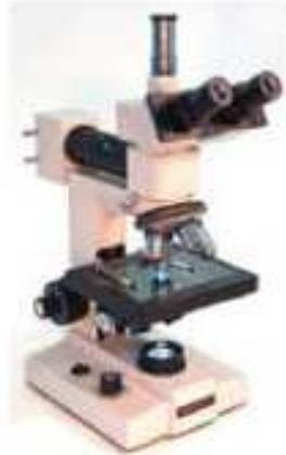
**Figura 2.9** Microscopio metalográfico
