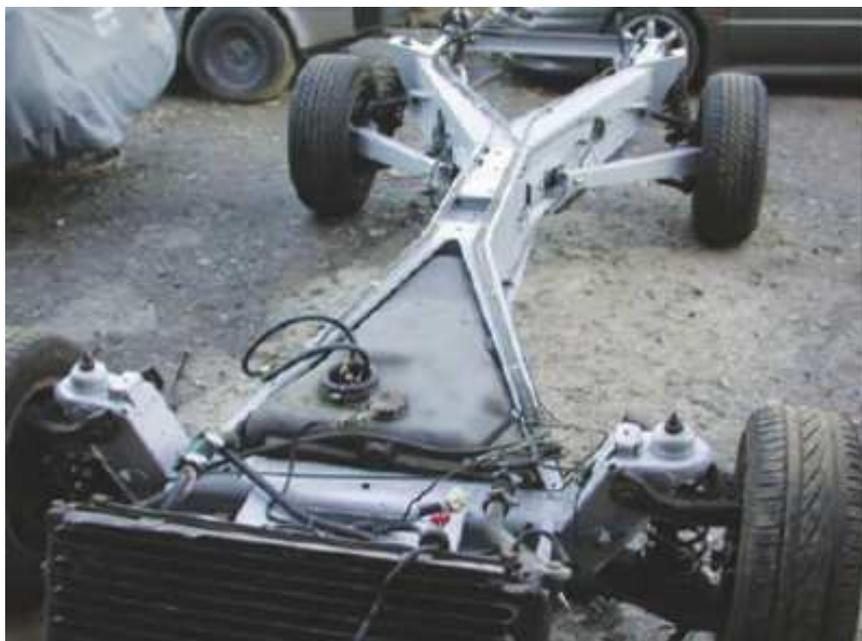
**Figura 1.3** Carrocería con plataforma chasis
