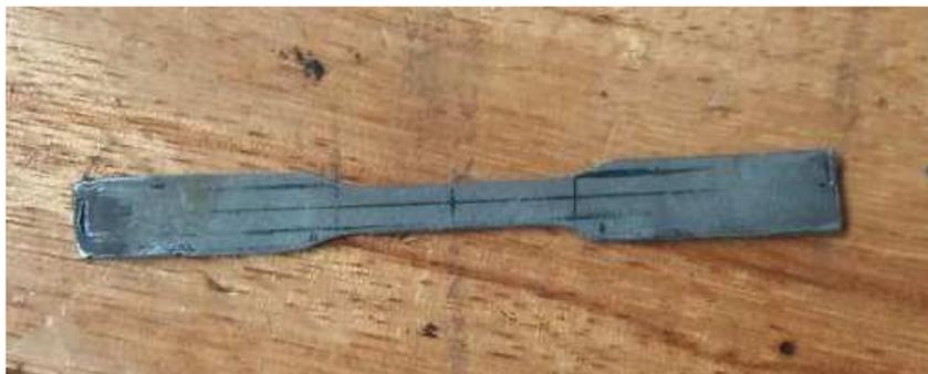
**Figura 4.10** Longitud calibrada
