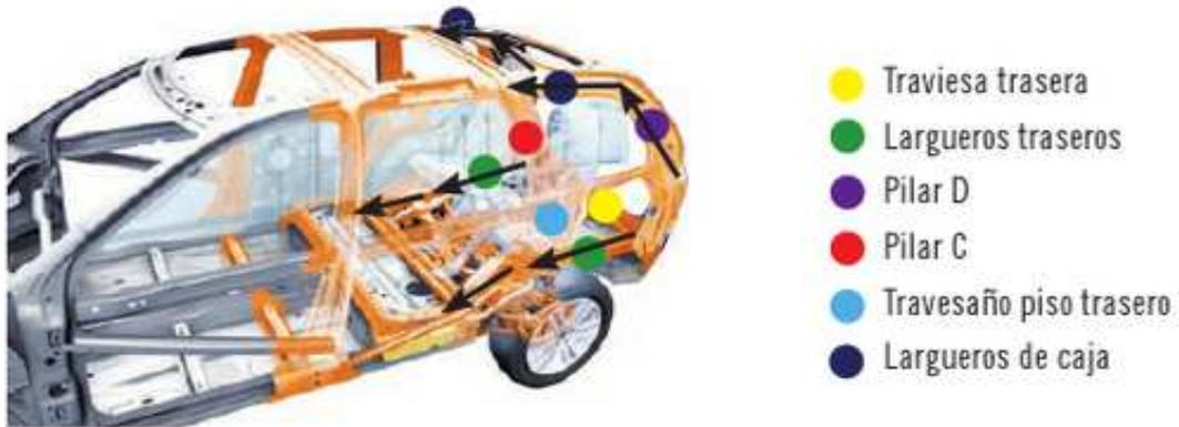
**Figura 1.10** Distribución de energía en una colisión posterior
