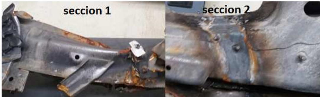
**Figura 4.3** Secciones impactadas del larguero
