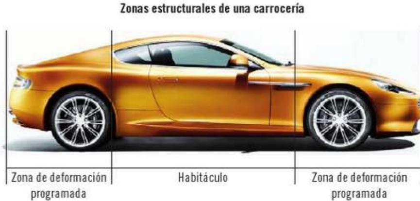
**Figura 1.6 Zonas estructurales de la carrocería**
