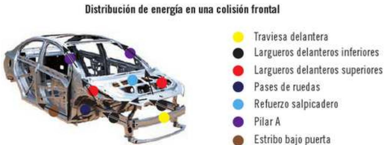
**Figura 1.8** Distribución de energía en una colisión frontal
