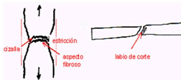
**Figura 2.16** Fractura dúctil
