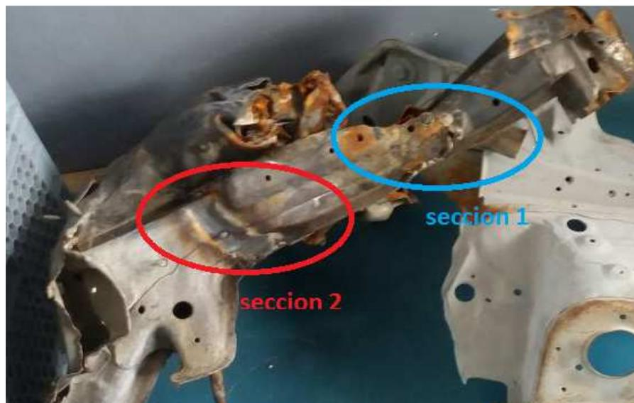
**Figura 4.2** Secciones para extracción de probetas
