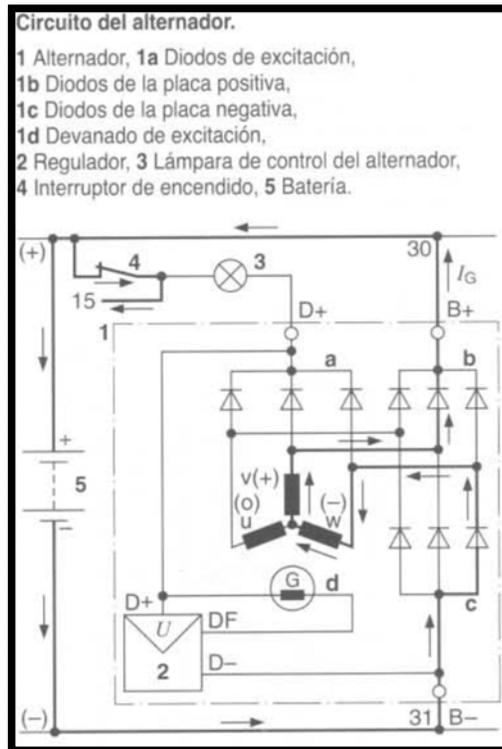
**Figura 13. Circuito del alternador**
