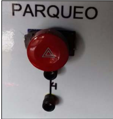
Figura 48. Interruptor de luces de parqueo
