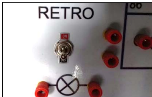
Figura 47. Interruptor de retro
