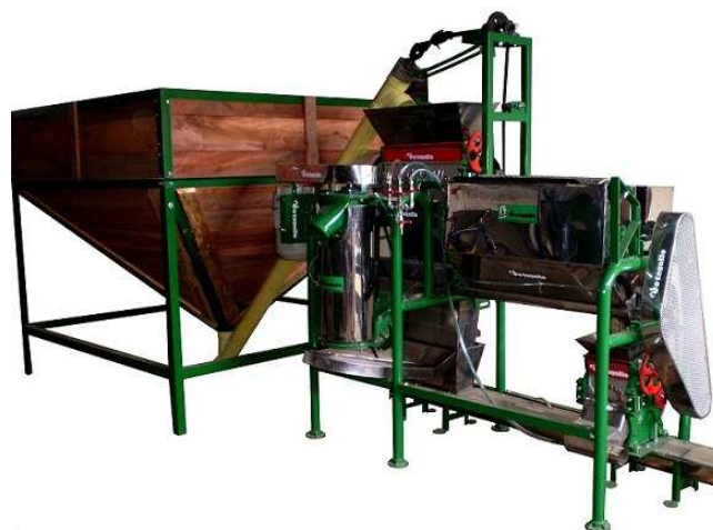
Ilustración 23. Módulo becolsub para despulpado de café en cereza
