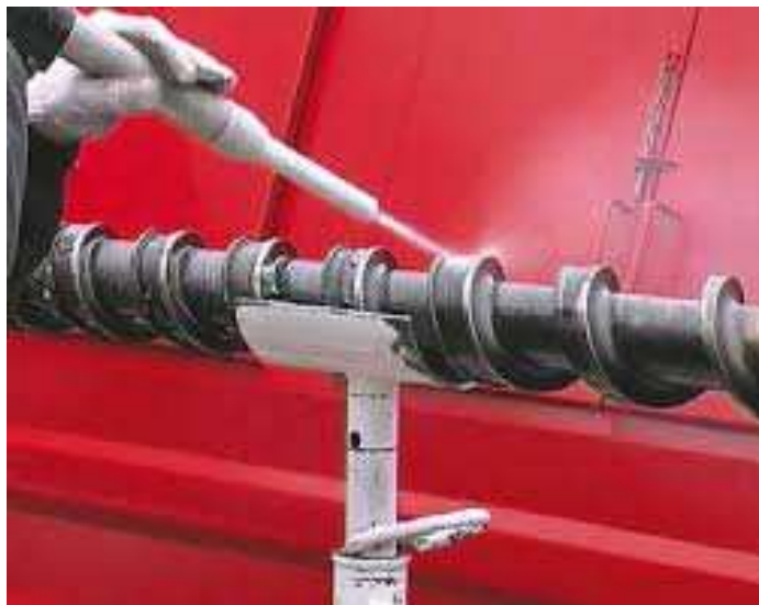
Ilustración 7. Limpieza de interiores de equipamiento con hielo seco
