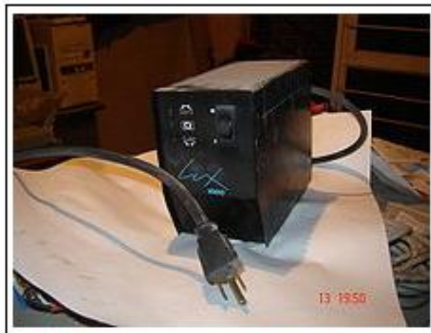
Figura 4.4 Regulador de Voltaje
