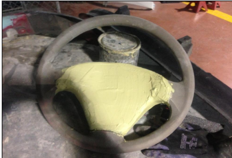
Figura 5.9 colocado el molde en la masilla
