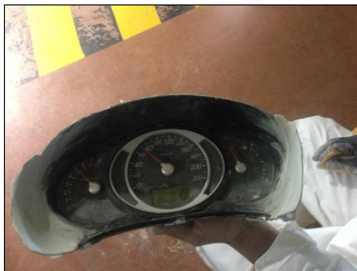
Figura 5.10 Adaptación del tablero
