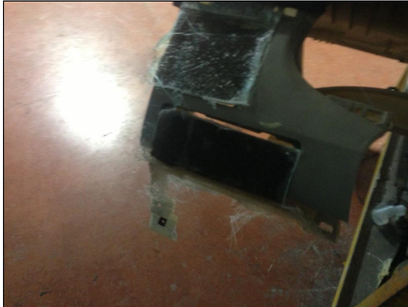
Figura 5.5 Adaptación de fibra en el tablero
