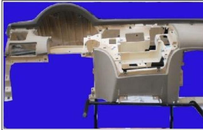
Figura 5.13 Soporte base de tablero
