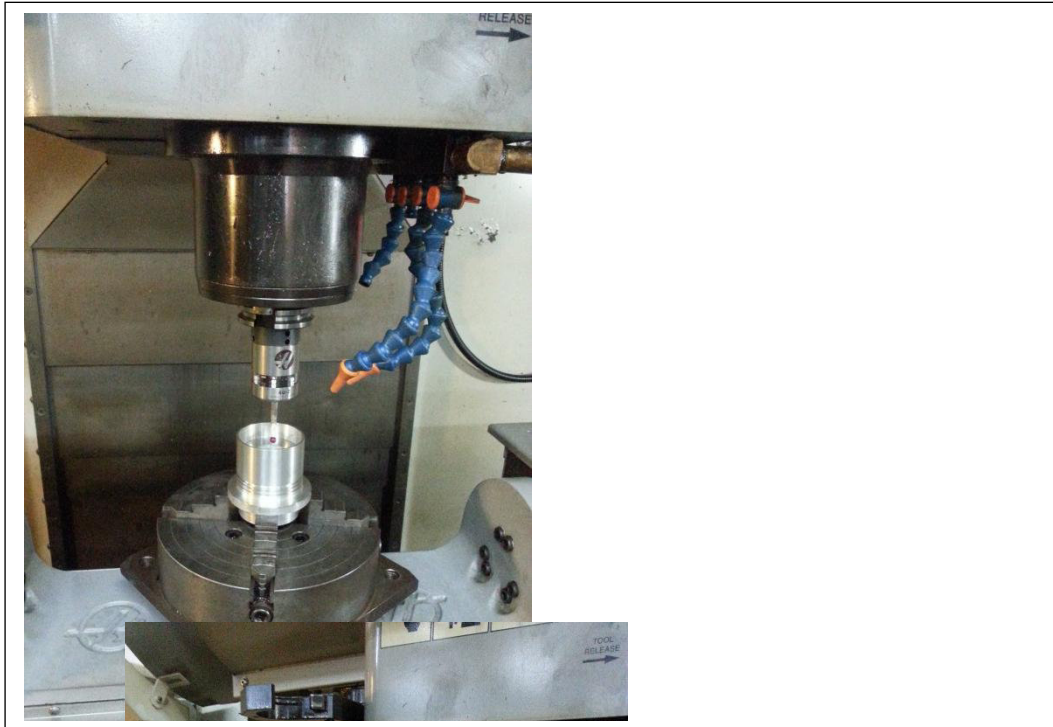
Figura 3.18 Determinación del origen pieza por medio de un sensor y reloj palpador
