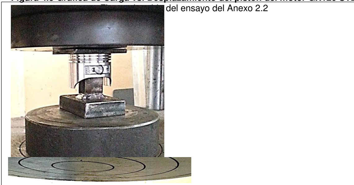
Figura 4.6 Pistón del motor GX120 STD, durante y luego del ensayo de compresión
