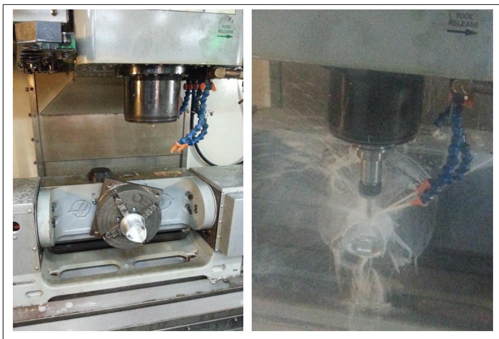
Figura 3.20 Giro de 90° y mecanizado en el costado del pistón
