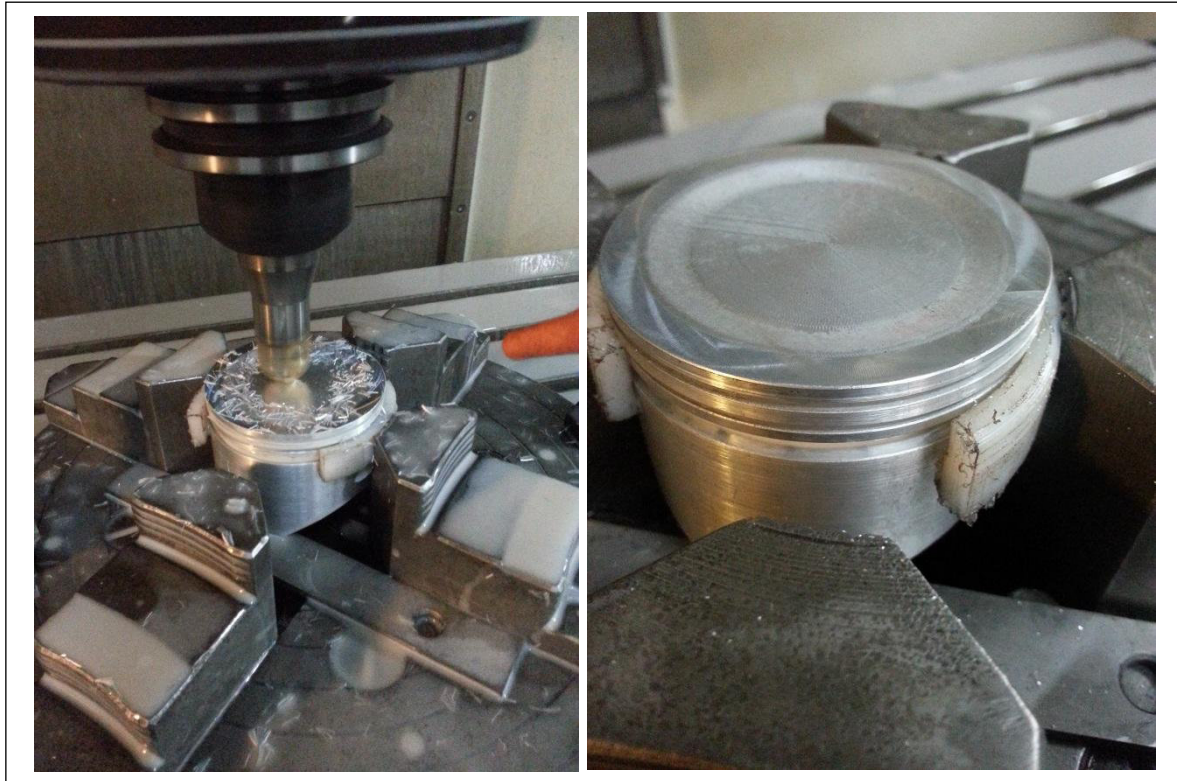
Figura 3.23 Giro de 90° y mecanizado en el costado del pistón Figura elaborada por: Xavier Guarderas
