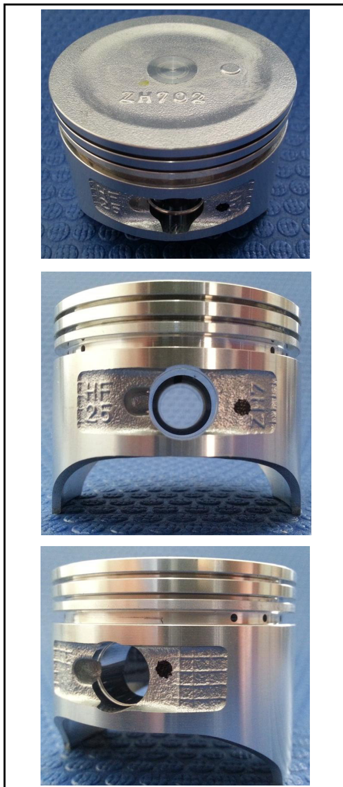
Figura 2.13 Vista externa del pistón del motor GX120 Fotografías tomadas por: Xavier Guarderas
