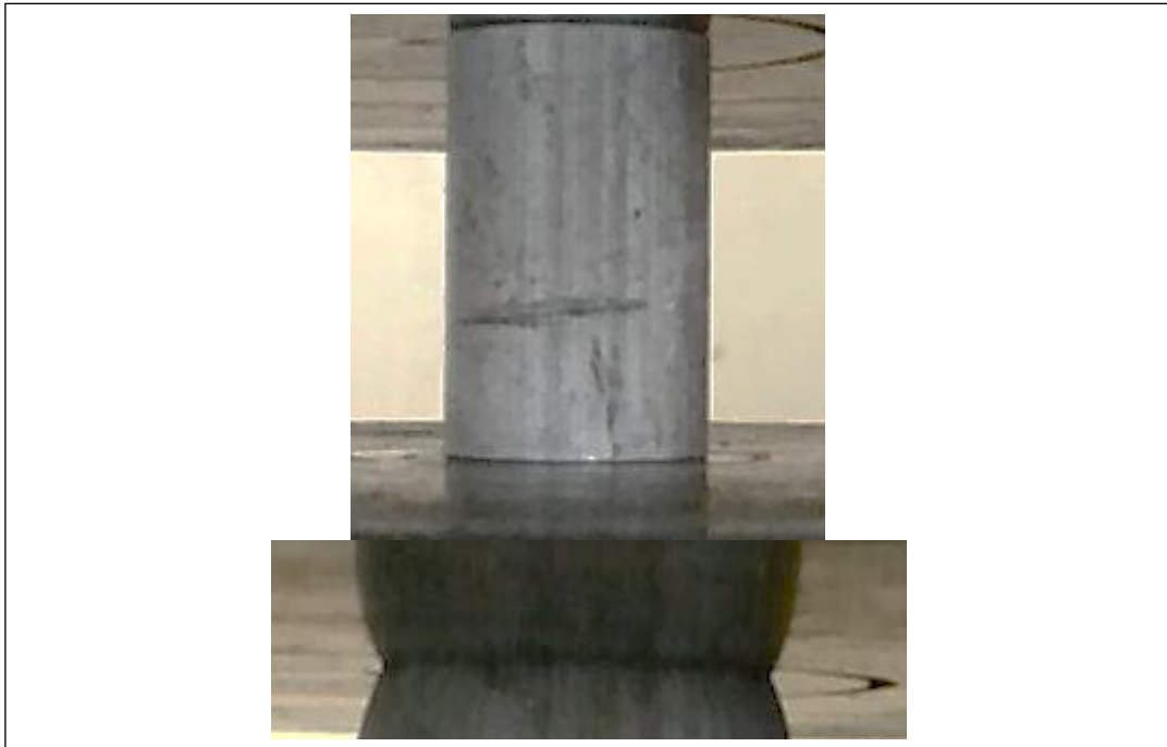
Figura 4.14 Probeta 2 antes y después del ensayo de compresión Figura elaborada por: Xavier Guarderas.
