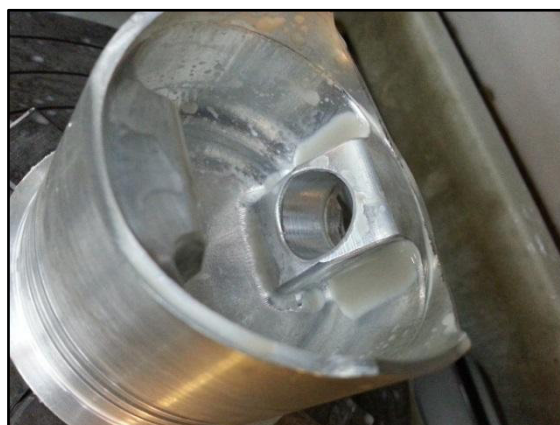
Figura 3.21 Pistón con un costado mecanizado y listo a mecanizarse el otro
