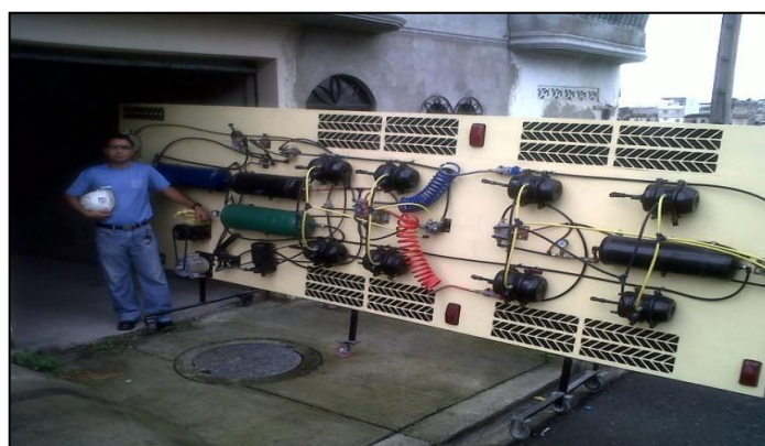
Figura 109: Módulo didáctico neumático en su armado completo.
