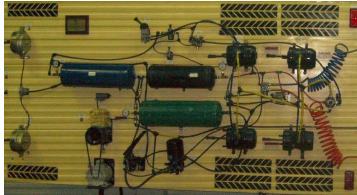
Figura 9: Tubería de los Tanques del módulo didáctico.
