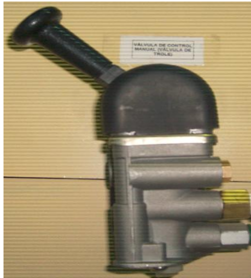
Figura 22: Válvula de control manual.
