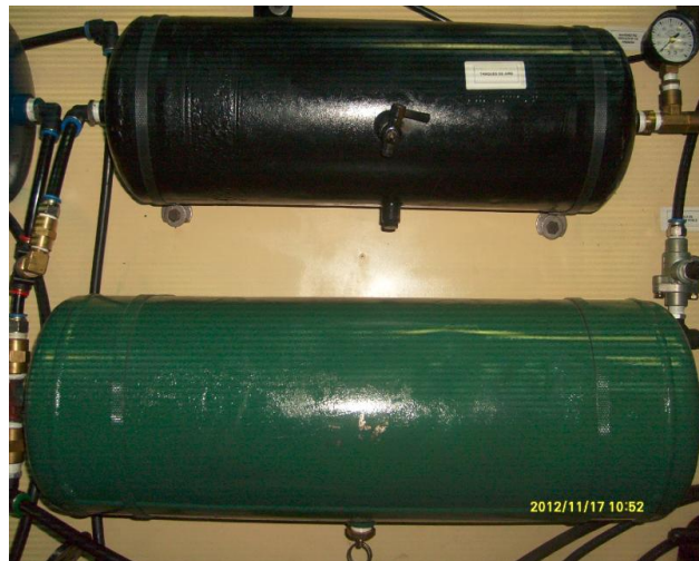
Figura 8: Configuración Típica de los Tanques
