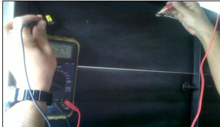
Figura 106: Chequeo de continuidad en línea negativa.
