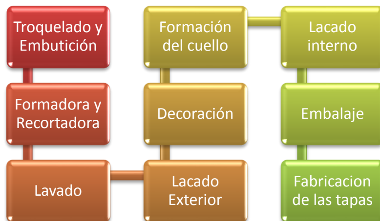
Fig. 3.1 Proceso de fabricación de Latas de aluminio para bebidas
