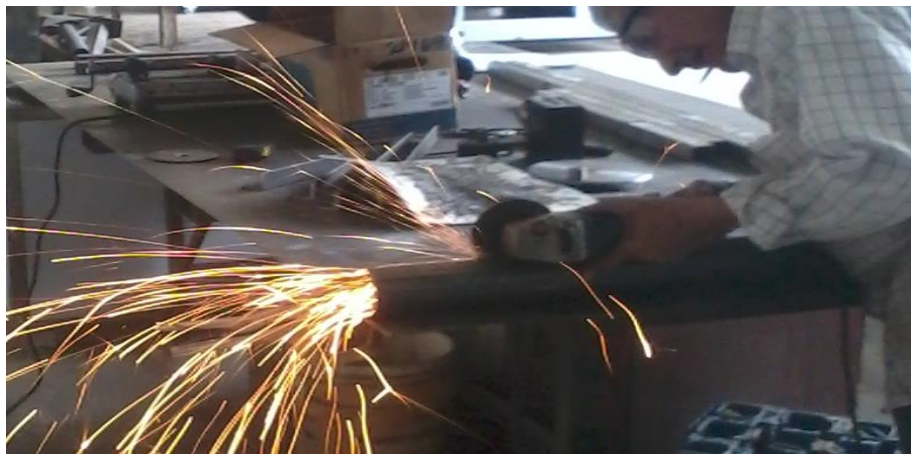
Fig. 3.31 Proceso de Corte del Tubo
