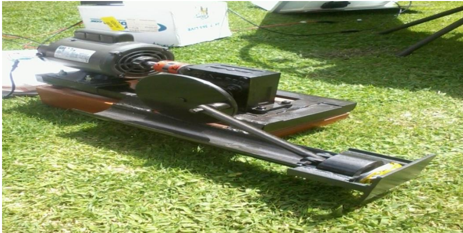
Fig. 4.2 Verificación de la compactación de latas
