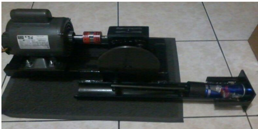
Fig. 4.3 Compactación de latas
