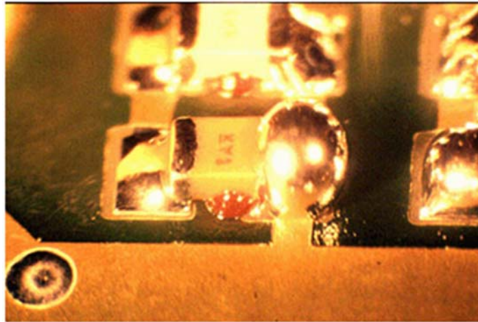
Figura 1. 32 Soldadura excesiva de elemento en PCB
