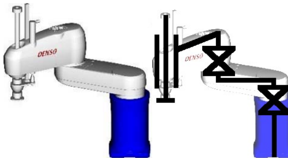
Figura 1. 7 Brazo robótico SCARA de 3 DOF (2 angulares y un prismático)
