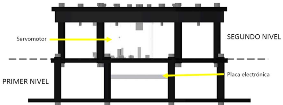
Figura 3. 6 Estructura de la base del manipulador referencia de PhantomX Reactor Arm
