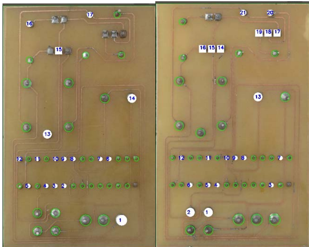
Figura 4. 19 Detección de errores en soldas en placa de circuito impreso grupo "Prueba Control Calidad". a) PLACA1. b) PLACA2. c) PLACA3
