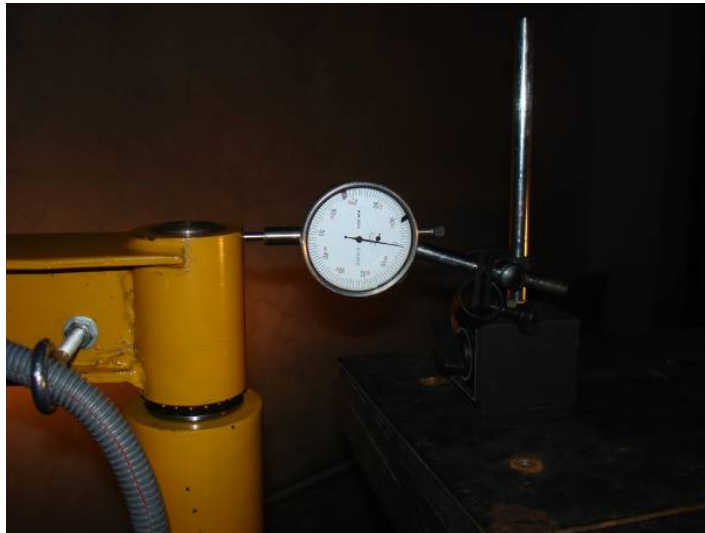
Figura 4.18 Prueba de deflexión de la columna 83
