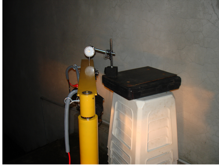
Figura 4.20 Prueba de deflexión de la viga 85
