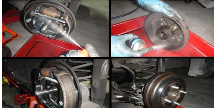
Figura 4.4: Limpieza y verificación de estado de componentes de frenos posteriores
