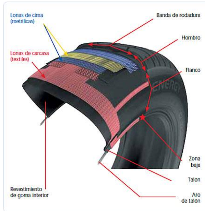
Figura 1.19: Estructura del neumático Fuente: ( EUROMASTER, 2016)
