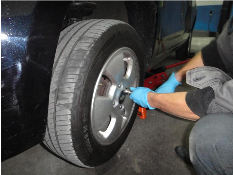
Desmontaje de los neumáticos para mantenimiento previo a pruebas de ruta
